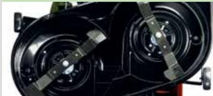
Das Schneidergebnis ist kaum zu toppen: Ein elektromagnetisches Messerkupplungssystem, bei den Schnittbreiten von 95 und 105 cm und ein synchrones Schneidwerk bei 125 cm mit zwei sogverstärkten Flügelmessern hinterlassen einen königlichen Rasen.
