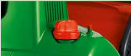
Zentrale, mehrstufig regulierbare Höhenverstellung der Messerwalze.
