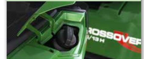
Wie beim Auto, lassen sich die Crossover Rasentraktoren einfach und schnell über den außenliegenden Tankstutzen mit Benzin befüllen - ganz ohne Anheben der Motorhaube.
