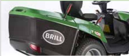
Die geräumige Grasfangbox kann bequem vom Fahrersitz entleert werden und ermöglicht dank 310 Liter Boxvolumen lange Mähintervalle. Optional entleert sich die Fangbox auch ganz automatisch auf Knopfdruck.
