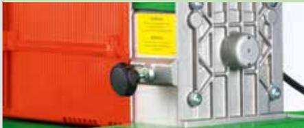
Einfaches nachjustieren der Gegenschneide über die Stellschraube.
