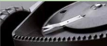
Das Doppelmesserschneidsystem reduziert nicht nur die Verschmutzung im Gehäuse, sondern zerkleinert auch den Grasschnitt. Dieser wird dem Boden als natürlichen Dünger zugeführt. Ein perfektes Schnittbild ist das Ergebnis.
