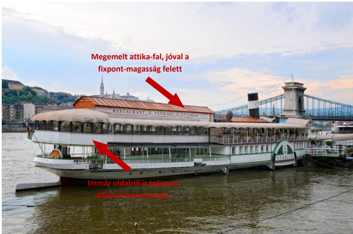
28. és 29. ábra: A hátsó nyitott napozófedélzet helyén kialakított zárt nagyterem kívülről (fent) és belülről (lent). Az alsó képen jól látható a hajó tetejéből az 1990-es években kiemelkedett „attika-fal” mögötti belső tér.
