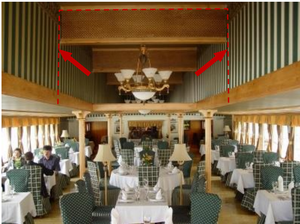
28. és 29. ábra: A hátsó nyitott napozófedélzet helyén kialakított zárt nagyterem kívülről (fent) és belülről (lent). Az alsó képen jól látható a hajó tetejéből az 1990-es években kiemelkedett „attika-fal” mögötti belső tér.
