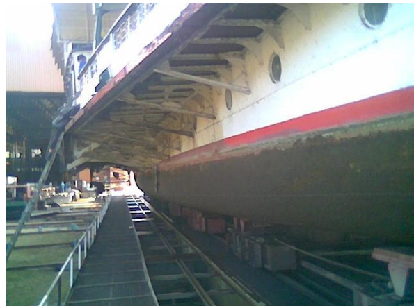
34., 35, 36., 37. és 38. ábra: A KOSSUTH kiemelése a hajógyári sólyán 2008.február 27-én (fent). Az elaggott héjlemezek (középen) és az új lemezelés (lent)
