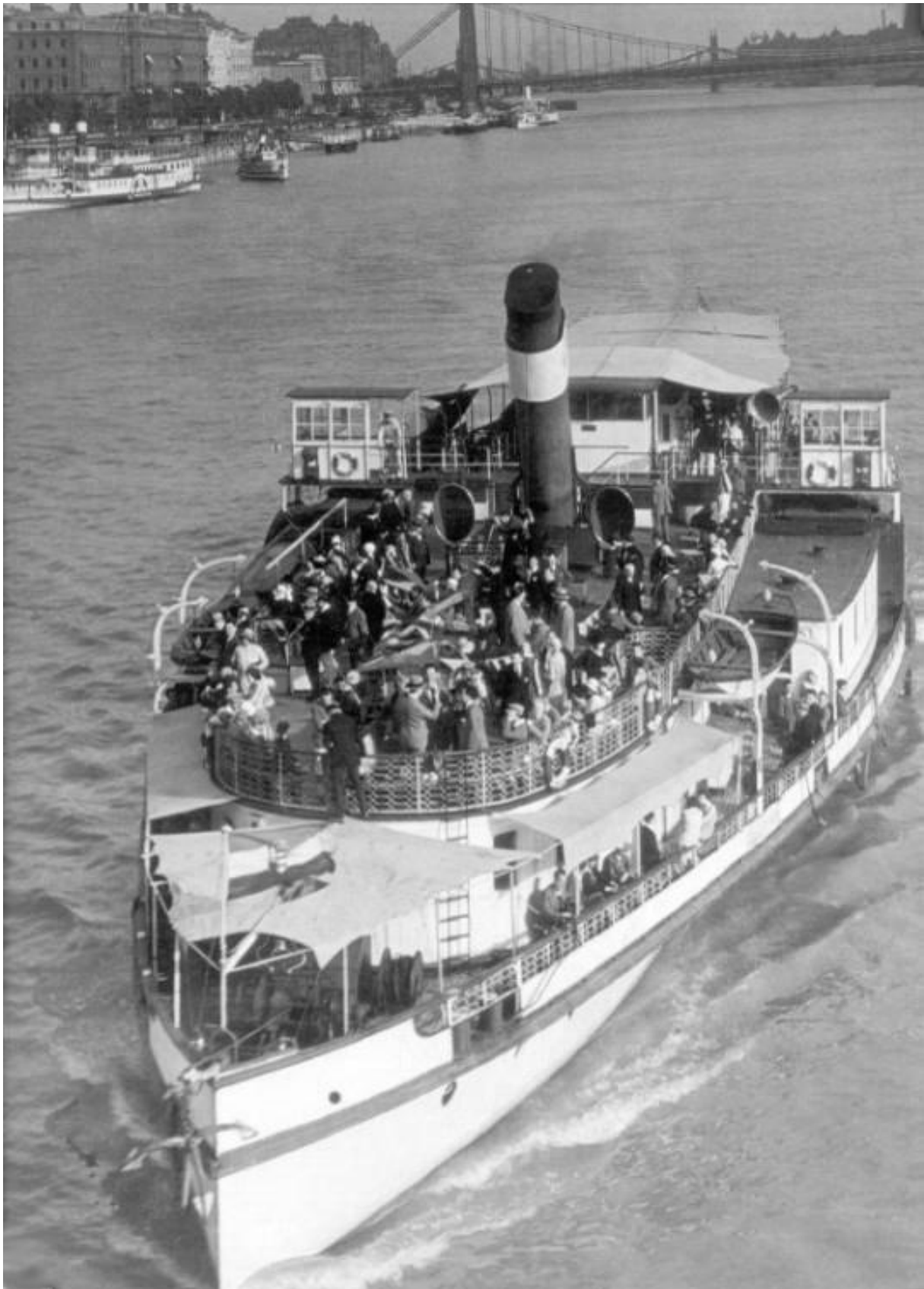
7. ábra: A LEÁNYFALU (ex-RIGÓ) 1929-ben. Érdekeség, hogy a parancsnoki híd és a kormányállás kémény mögötti elhelyezése miatt a hajó kéményét nem hátrafelé, hanem előre billentették a hidak alatti áthaladás idején.
