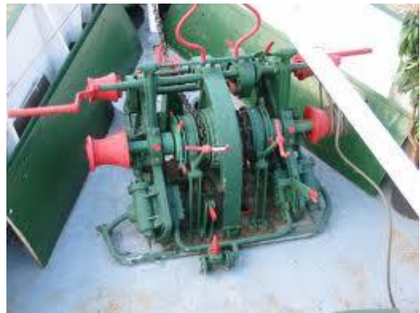
52. és 53. ábra: A lapátkerék és a gőzcsörlő (talapzatán két oldalt jól láthatók a gőzhengerek)
