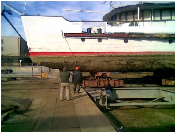
34., 35, 36., 37. és 38. ábra: A KOSSUTH kiemelése a hajógyári sólyán 2008.február 27-én (fent). Az elaggott héjlemezek (középen) és az új lemezelés (lent)
