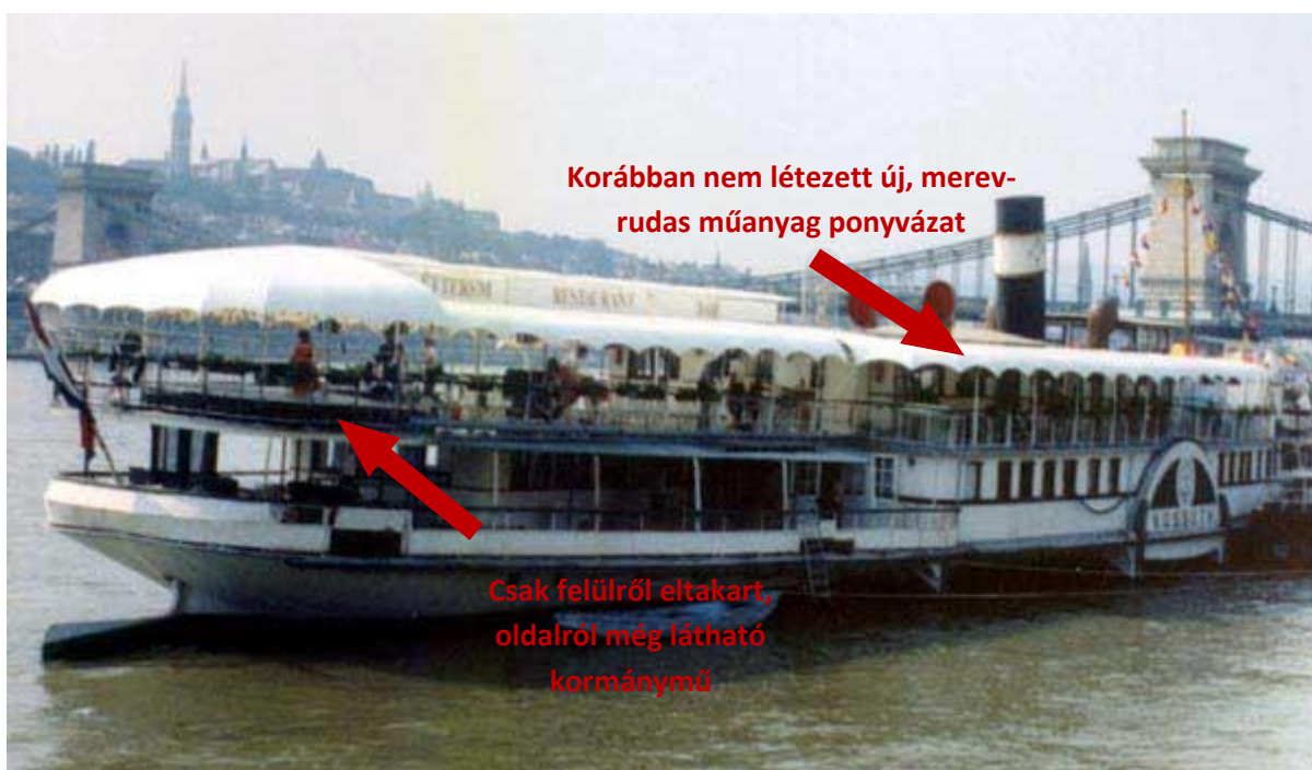
27. ábra: A KOSSUTH közvetlenül a 2000-2003-as átalakítás előtt. Az egészen addig – az eredeti kivitellel összhangban könnyen lebontható – ponyvatartó rudazat és a könnyű vászon-ponyva helyébe bonthatatlan (hegesztett) csővázas rudazat és műanyag-ponyva került, amely a korábbiakkal ellentétben immár a lapátkerékházat is lefedte.
