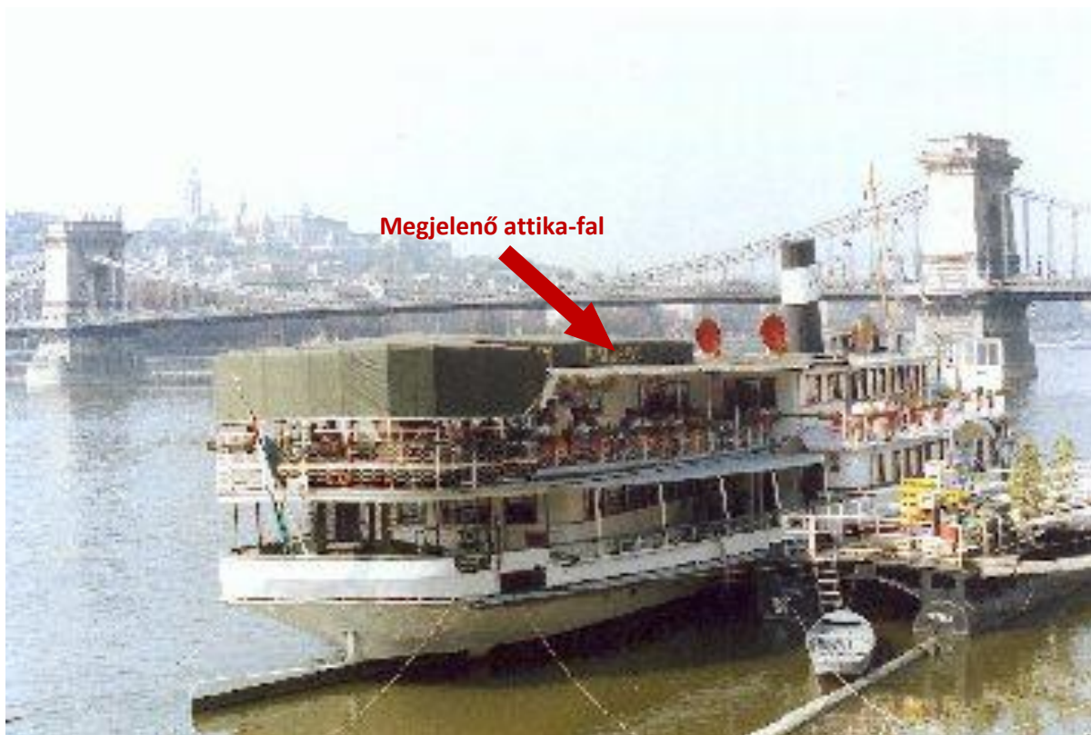
26. ábra: A KOSSUTH felépítményének hátsó része a tat felől az 1990-es években. A 17-es, 18-as és 21-es képekkel összehasonlítva jól látható, hogy a hátsó nyitott napozófedélzet feletti ponyva tetejéből – a hajó középvonalán – kiemelkedik egy kb. 1-1,5 m magas attika-fal szerű tetőszerkezeti elem, amely reklámhordozóként szolgál.
