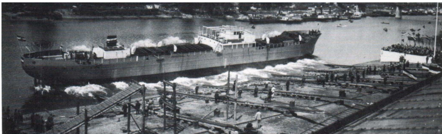
A TISZA a vízrebocsátás előtt a sólyatéren. Jól láthatók a beállított kormánylapátok.
