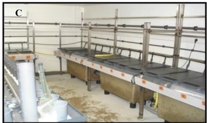
Figure 14 : Dispositif expérimental du circuit normoxie-hypoxie : a) Incubateurs après dépôt des œufs, b) Augettes contenant les incubateurs, c) Ensemble du dispositif.
