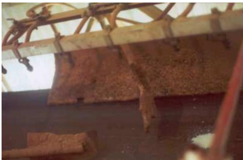
Bico de pulverizador sobre a massa de grãos que correia transportadora
