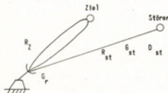
Ohne Störer würde das Ziel in der Entfernung  $R_0$  erkannt.  $\left(\frac{N}{S} \text{ für } \bar{R}, \bar{P}\right)$
