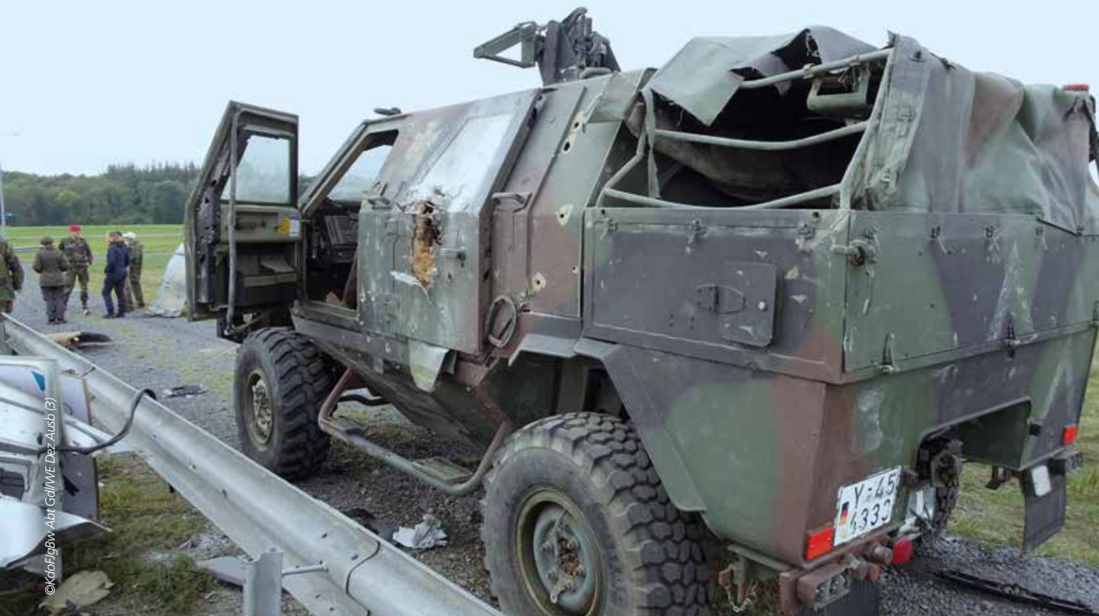
Dingo 2 nach Umsetzung eines gerichteten IED.
