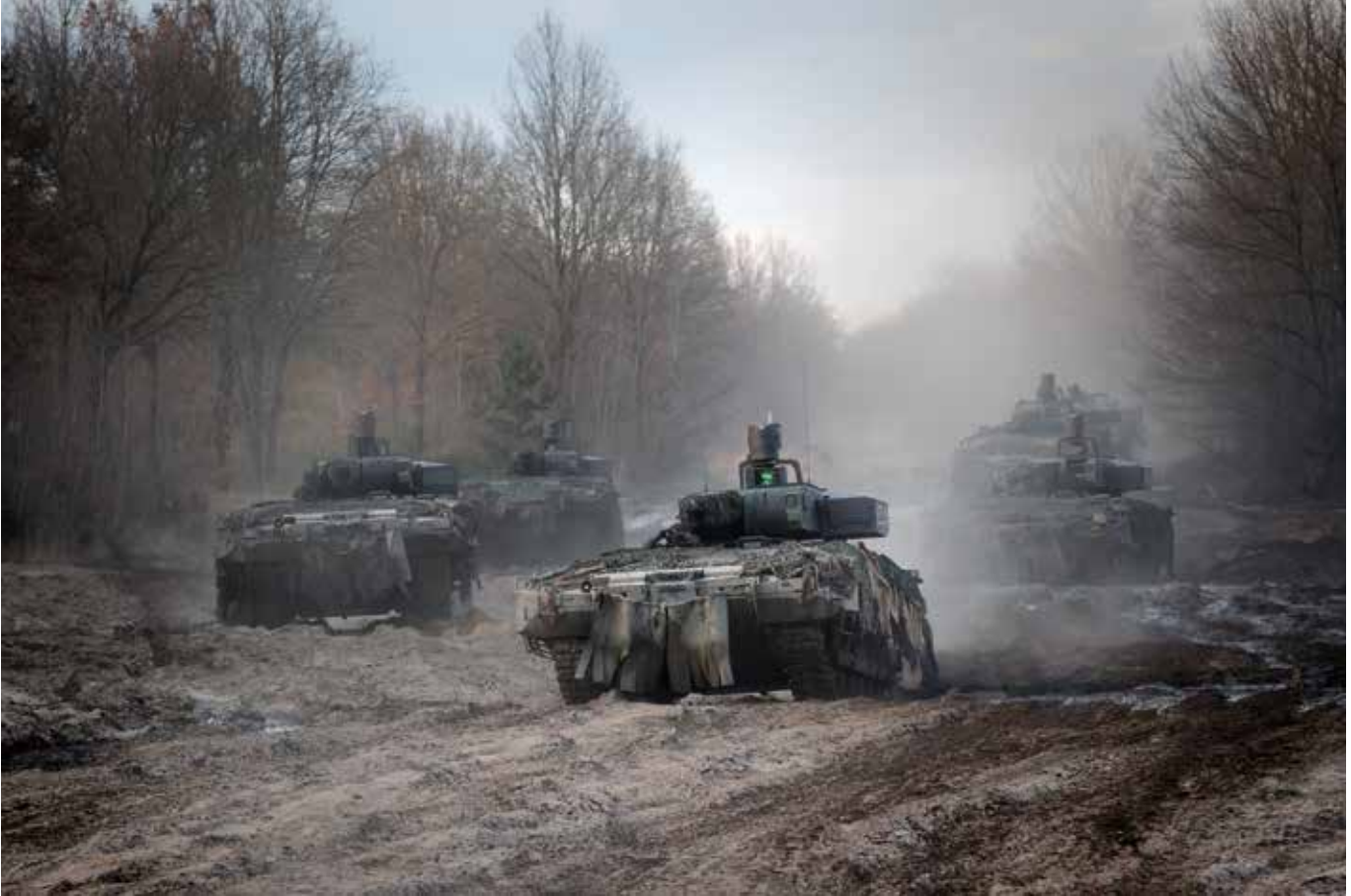
Einsatzbereit und siegfähig: Schützenpanzer Puma VJTF nähern sich ihrem Verfügungsraum an. Dank der neuen Lenkflugkörper Spike LR, verschossen aus dem rechts am Turm integrierten Panzerabwehrsystem MELLS, können auch feindliche Kampfpanzer mit dem modernsten Schützenpanzer treffsicher vernichtet werden.
