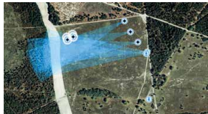
Die unterschiedlichen Sensoren sind zu einem Netzwerk verbunden, das eine Überwachung großer Gebiete ermöglicht.
