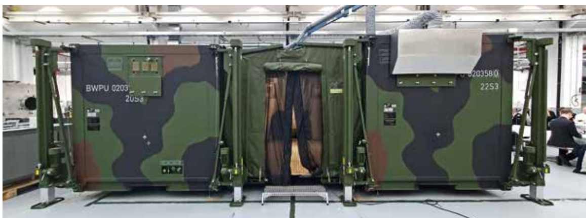
Das neue System Mobile Feldküche (MobFKü) der Bundeswehr aufgebaut. Links der Peripheriecontainer, mittig die Zugangsschleuse, rechts der Küchencontainer. Im Betrieb steht das System abgestützt und nivelliert auf den HETEK-Stützen.
