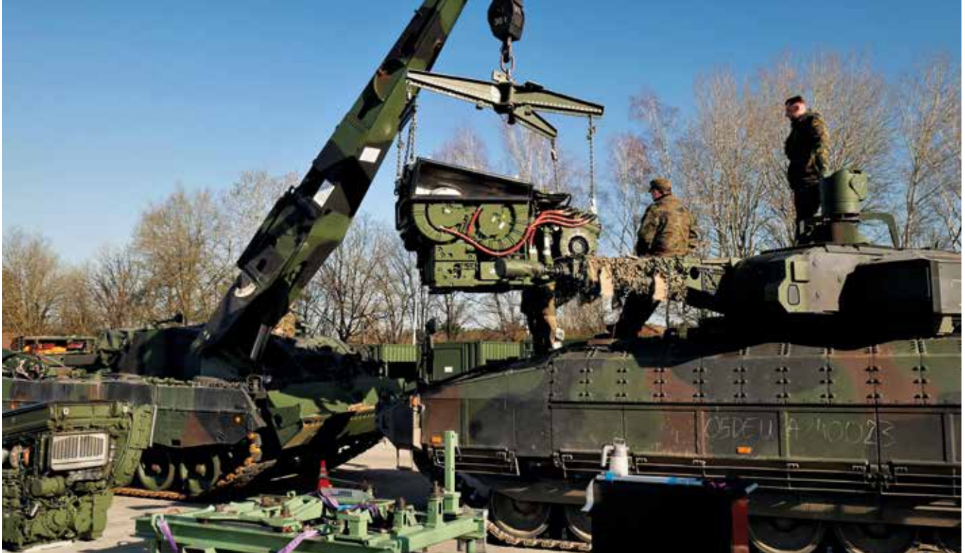
Instandsetzungsmaßnahme an einem Schützenpanzer Puma, hier Triebwerktausch mithilfe des Krans eines Bergepanzers. Solche Arbeiten würden auch noch im Brigadeversorgungspunkt erfolgen können.
