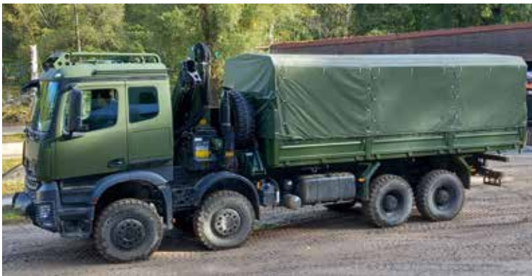
Arocs 4152 AK 8 x 8 mit den Ausmaßen 10,07 x 2,50 x 3,71 m (L,B,H) mit einem Gesamtgewicht von 35 t mit Palfinger-Kran, schwenkbar 400 Grad und Seilwinde.
