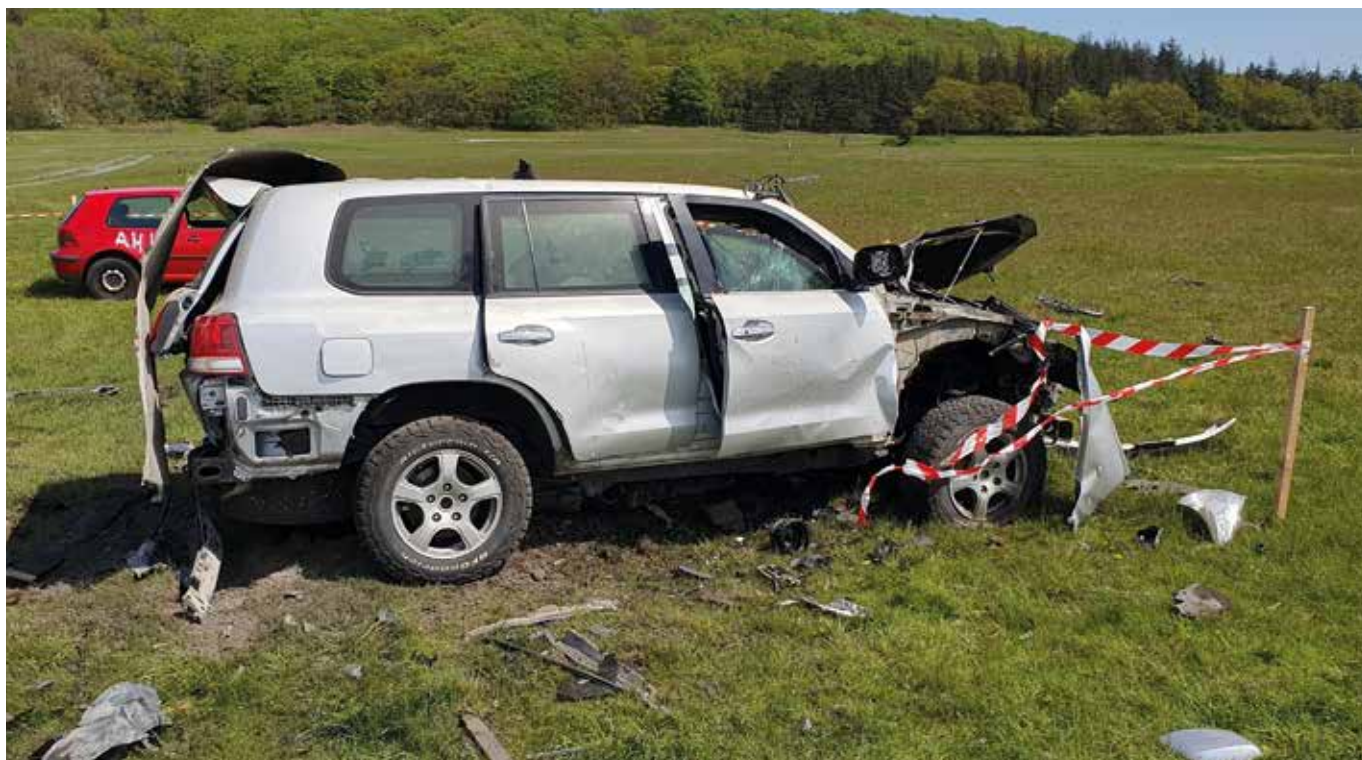
Sondergeschützter Toyota Landcruiser nach Umsetzung IED.
