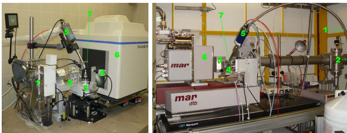
4.4.1.ábra A diffraktométer részei. (Balra: diffraktométer forgóanódos sugárforrással, image plate detektorral; jobbra: mérőállomás a DESY szinkrotronnál CCD detektorral. 1: sugárforrás, 2: optika, 3: goniométer; 4: kamera; 5: hideg nitrogéngáz fúvókája (alacsony hőmérsékletű méréshez); 6: detektor; 7: direktsugár fogó
