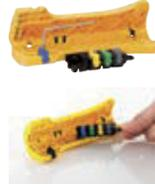
Kraft- und Höhenbegrenzer für die Entmantler Uni-Plus und Allrounder. Das präzise Einstellen der Klingenabstände (Ø 4,0 - 11,9 mm) auf die Mantelstärke ermöglicht ein prozesssicheres Arbeiten.
