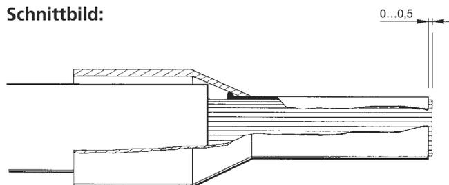
Die Isolation des Leiters muss in den Kunststoffkragen geschoben sein. Das Rohr der Hülse muss vollständig von dem Leiter ausgefüllt sein. Der Leiter sollte je nach Querschnitt ca. 0...0,5 mm aus dem Hülsenrohr überstehen.
