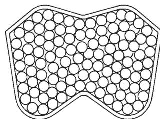
Die Crimpform ist bei den Querschnitten 6...50 mm<sup>2</sup> annähernd gleich.
