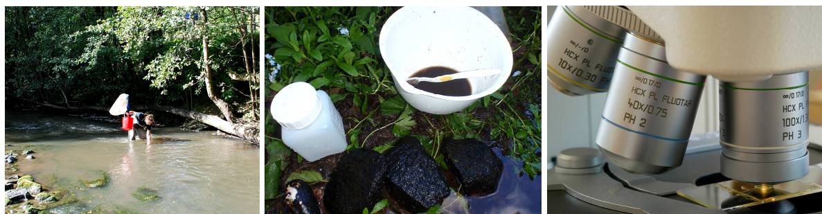
Figur 1. Provtagning av kiselalger. Analysen görs i ljusmikroskop i 1000 gångers förstoring med oljeimmersionsobjektiv. Mikroskopet ska helst vara utrustat med interferenskontrast, vilket gör att man kan se mycket små former tydligare än med andra tekniker (© Medins Havs- och Vattenkonsulter AB).
