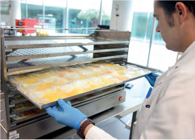
► Figura 6. Concentrados de plaquetas en un armario agitador. Imagen cedida por gentileza del Banc de Sang i Teixits de Barcelona.
