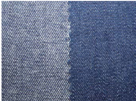
Abb. 84 | Denim ist ein Kettkörper: Die Kette ist blau, der Schussfaden weiss.
