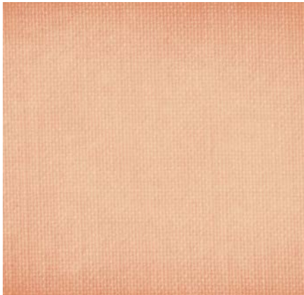
Abb. 83 | Textur einer Leinwandbindung
