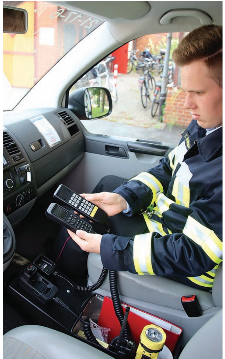
Oberfeuerwehrmann Torben Brennecke (Ortsfeuerwehr Koldingen) zeigt die beiden Bedienteile zu den Funkgeräten: links digital (neu), rechts analog (alt).
