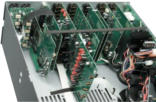
Wyjścia XLR załączone przekaźnikami NEC-a.
