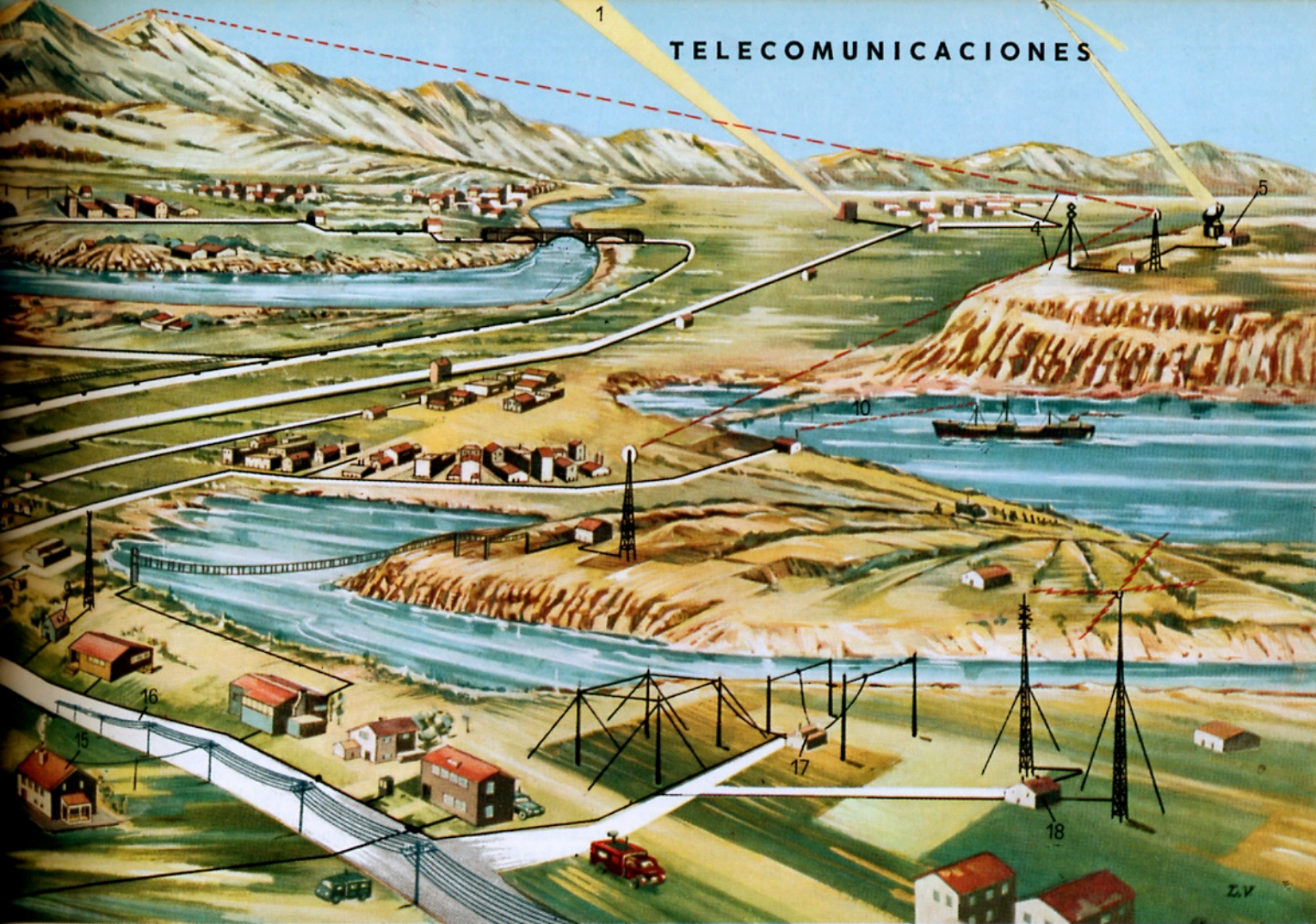
En este grabado se representan los diversos sistemas de telecomunicación que el ingenio del hombre ha creado en su incesante trabajo en pos del progreso y de su propio perfeccionamiento: 1) comunicaciones efectuadas por medio de un haz de ondas de radio; 2) sistema de comunicación entre la torre de control y un avión en vuelo (estas comunicaciones también se efectúan por medio de ondas de radio); 3) cable telefónico submarino; 4) enlace por microondas; se halla dotado de un cierto número de estaciones repetidoras y sirve para transportar comunicaciones telefónicas, telegráficas, de televisión, etc.; 5) estación terminal de un sistema de comunicación efectuada con la intervención de satélites artificiales; 6) central telefónica; 7) cables telefónicos subterráneos; 8) central telefónica secundaria; 9) estación terminal de un enlace hertziano para comunicaciones telefónicas; 10) sistema de comunicaciones entre un buque y una estación radiomarítima para ayuda a la navegación: está enlazado a la red telefónica con el objeto de permitir comunicaciones telefónicas privadas; 11) antenas parabólicas de una estación de un enlace hertziano; 12) teletipo; 13) telefoto; 14) centralita telefónica manual: se emplea para comunicaciones interurbanas; 15) usuario telefónico; 16) hilos telefónicos; 17) estación de radio comercial; se utiliza para la transmisión y recepción de comunicaciones efectuadas por medio de telégrafo, teléfono, telefoto, teletipo; 18) estación emisora de programas radiofónicos y de imágenes televisadas.
