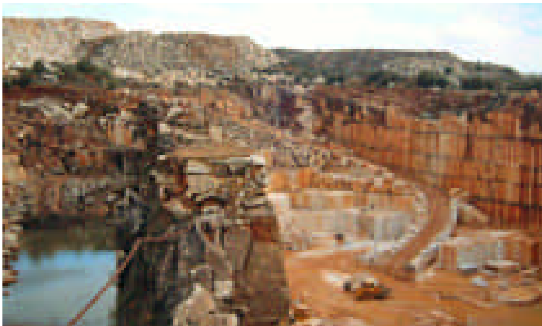
Fig. 4.70 – Vista geral para Leste da Pedreira “Batanete” – Olival Grande, flanco SW do anticlinal de Estremoz. A zona mais escura, representada à esquerda do promontório, corresponde a um filão dolerítico que separa a exploração abandonada à esquerda e a pedreira onde a exploração se desenvolve em bom ritmo extractivo. A separação de pedreiras por cabos reais é uma situação muito frequente no anticlinal de Estremoz. Normalmente, na terminação periclinal SE, o bloco situado a SE sofre um abatimento. Nas imediações destes filões o mármore encontra-se mais fracturado.
