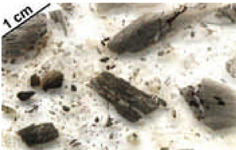
Fig. 4.29 – Imagem captada em scanner e digitalmente realçada de uma talisca dos carbonatos detríticos da estrutura de Ferrarias. Repare-se no aspecto desorganizado dos fragmentos líticos que denuncia o grau de deformação incipiente a que as rochas foram submetidas. Em todas as lâminas aqui representadas o plano em observação obteve-se por um corte segundo a lineação de estiramento mineral e perpendicularmente ao fabric planar identificado macroscopicamente.
