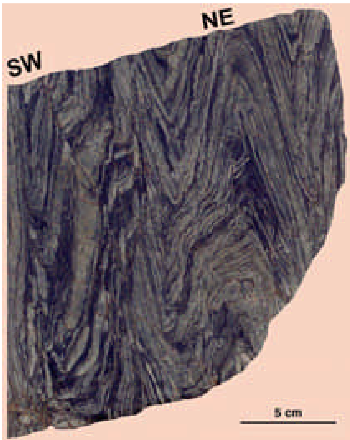
Fig. 4.85 – Secção polida, perpendicular ao fabric S/L, em amostra constituída pela alternância de xistos pelíticos cloríticos (mais escuros) e xistos siltíticos. A amostra foi colhida próximo da Horta do Rezio a Leste de Borba e cerca de 1000 metros a NW do v.g. Mina. Esta amostra ilustra, à escala da amostra de mão, as estruturas e padrões de dobramento que se observam à escala mesoscópica.
