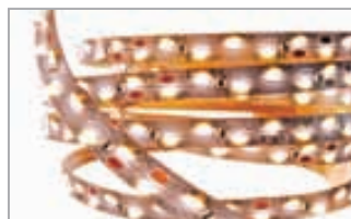
Maße 3000 x 9 x 2mm Farbtemperatur 2700K (+/- 150K) LED Farbe warmweiß
