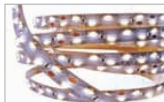
Maße 3000 x 9 x 2mm Farbtemperatur 6500K (+/- 150K) LED Farbe kaltweiß
