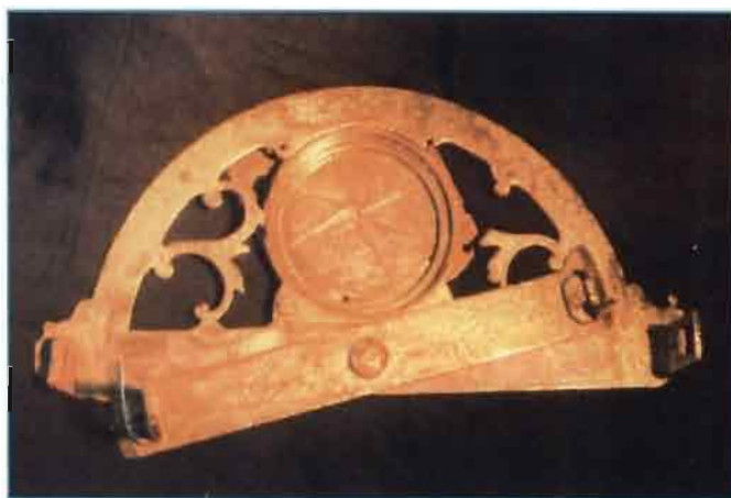
Le même après traitement. Cet appareil appelé aussi demi-cercle d'arpentage, comporte deux alidades à pinnules et une boussole d'azimut. (P. Larue).
