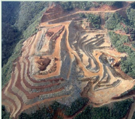
Figure 6.48 : Verse avec topsoil étalé sur les banquettes (verse Newco, Kouaoua).
