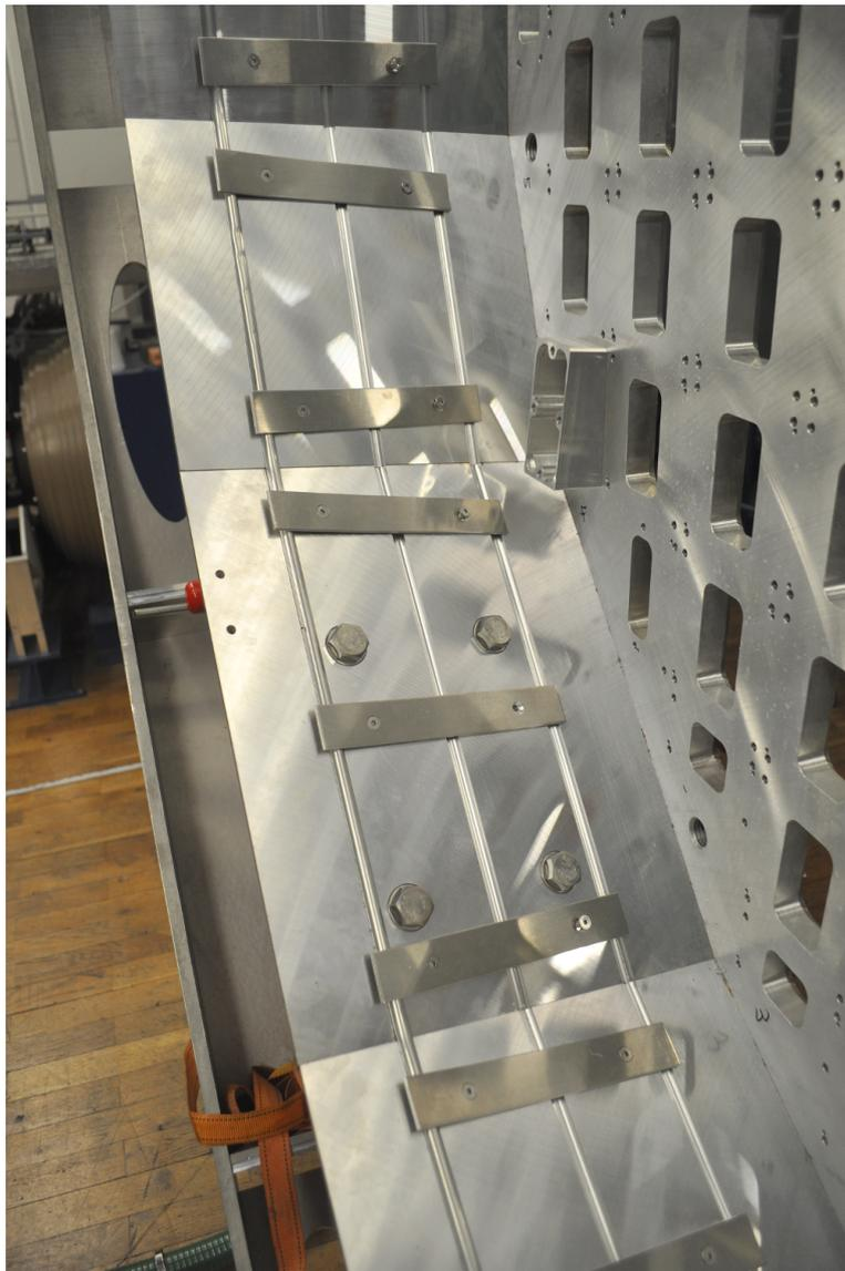
**Abbildung 9.1:** Ausfräsungen im Stiffener-Ring der Vorwärtsendkappe zur Aufnahme der Kühlleitungen der Seitenkühlung. Links: Ausfräsung mit eingelegtem Aluminiumrohr. Mittig und rechts: Ausfräsungen ohne Rohre.
