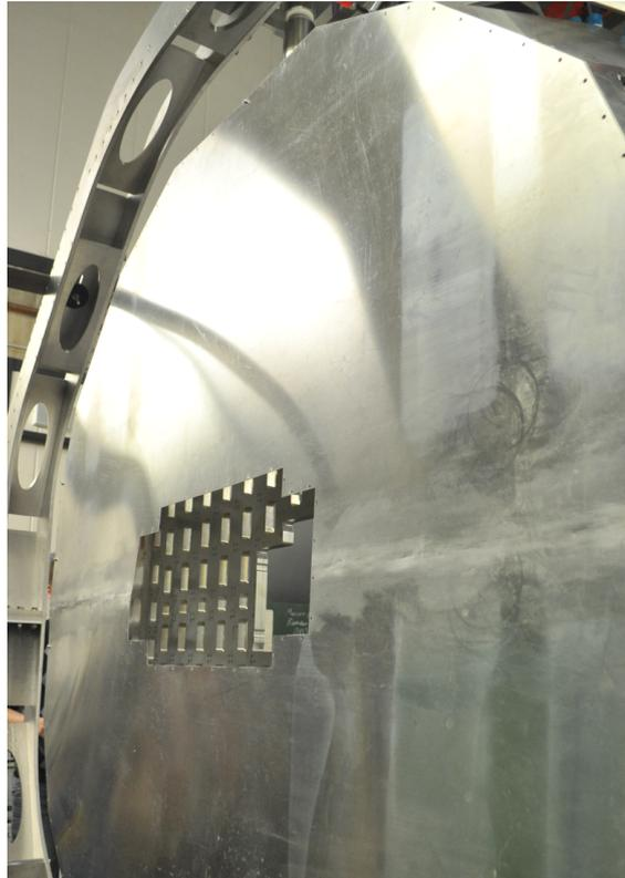
**Abbildung 9.9:** Außenseite der Aluminiumfrontplatte der Vorwärtssendkappe des EMC
