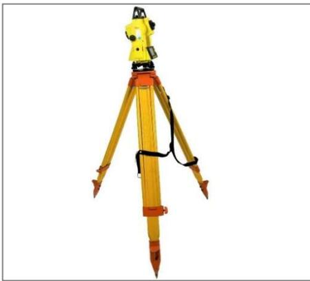
Abbildung 39: Bautachymeter zur Ermittlung der Baumgeometrie (Eigene Darstellung)
