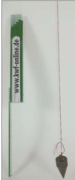
Abbildung 13: Hilfsmittel zur Hangbestimmung
