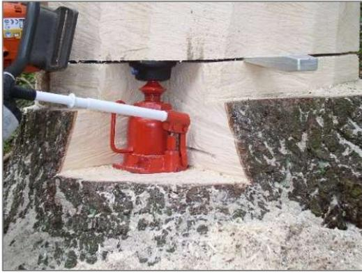
Abbildung 26: Hubzylinder (KWF e.V.)
