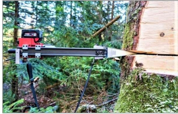
Abbildung 27: Fällkeil „TR300“ (KWF e.V.)
