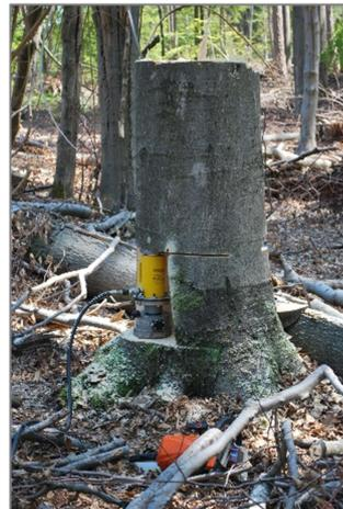
Abbildung 88: Hubkraftermittlung an einem Hochstumpf (Eigene Darstellung)
