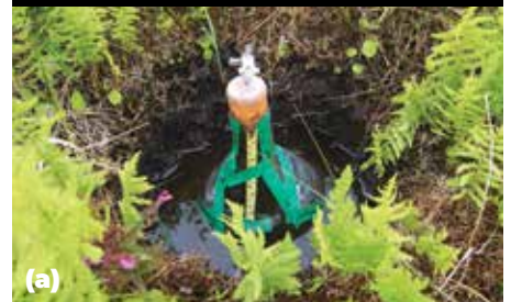
(a) Trapiau twndish (b) siambrau a'r (c) system cydamrywiad trolif i fesur llifoedd nwyon mewn mawndiroedd
