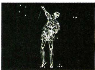
Wenn Sie ganz genau hinsehen, entdecken Sie bei der Dame im rechten Bild viele kleine Sender, welche die Daten eines Bewegungsablaufs an den Computer übertragen. Dieses Verfahren nennt man „Full Motion Capturing“. Links sehen Sie schließlich das Resultat.
