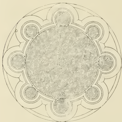
PARTICOLARI DELLA BASE DI UN PILONE FRA LE NAVI MAGGIORE E MINORI
