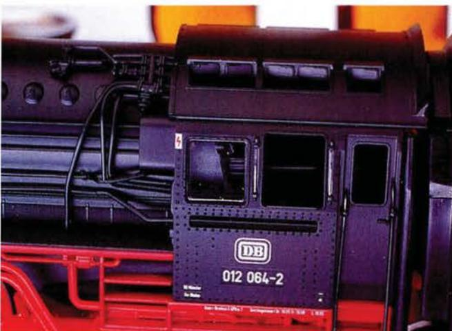
Viele angesetzte Teile – bis hin zu Windabweisern an den Führerstands Fenstern – runden den guten Eindruck ab.
