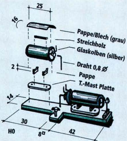
So entsteht aus einer Leuchtstoffröhre eine Weichenheizung.
