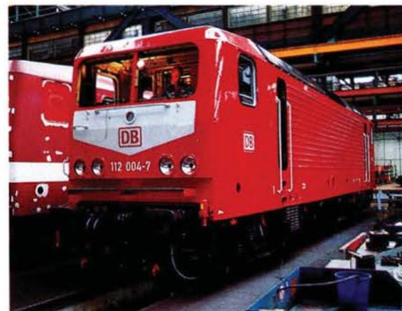
Die nun mit Frequenz-Multiplexer Wendezugsteuerung ausgestattete 112 004
