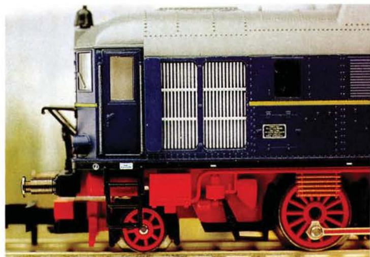
Leitblech beim Kühler, winziges Fabrikschild, exakt gefertigte Aufstiegleiter: N-Modellbau auf hohem Niveau.
