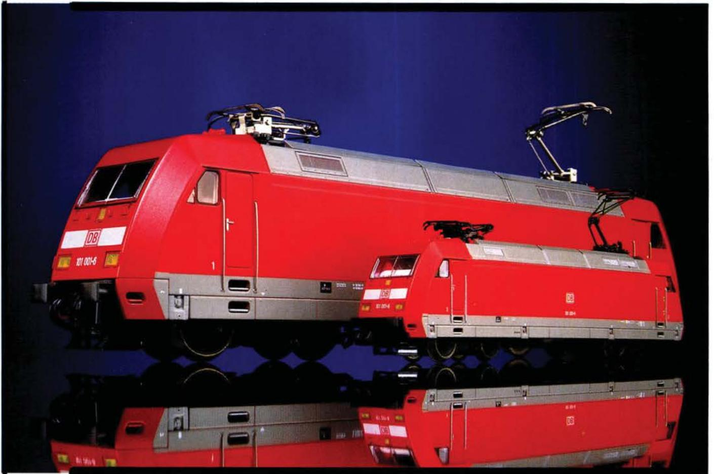
auf und setzt auch mit ihrer sonstigen technischen Ausführung neue Maßstäbe im N-Bereich. Der neu entwickelte, besonders zierlich ausgeführte, aber trotzdem voll funktionsfähige Stromabnehmer ist eine wahre Augenweide für N-Fans. Ein starker Fünfpol-Motor mit zwei dynamisch gewuchteten Messingschwungscheiben und
