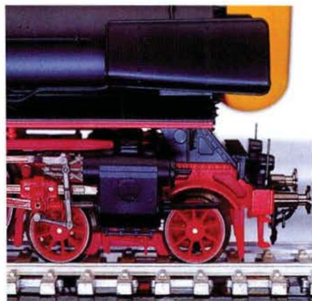
Die meisten Teile der Steuerung des Modells bestehen aus Metall, der Voreilhebel aus Kunststoff.
