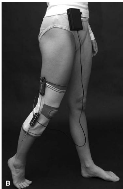
Figure 2 Utilisation du Bioback® pour le contrôle du genou lors de la marche (A, B).
