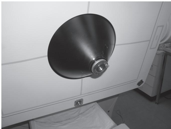
Fig. 4.5. – Gammacamera équipée d'un collimateur sténopéique.
