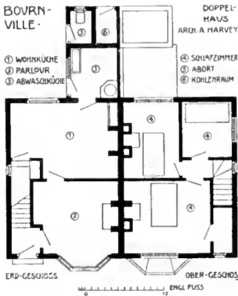
DOPPELWOHN- HAUS Wohnküche 11 F. 5 Z. × 16 F. 6 Z.; Parlor 11 F. 4 Z. × 13 F. 3 Z.; Abwaschraum etc. Obergeschoß: 3 Schlafzimmer und Schrankraum. Kosten i. J. 1899 für ein Haus 230 £. 16859 Cub. F. à 3 1/4 d.
