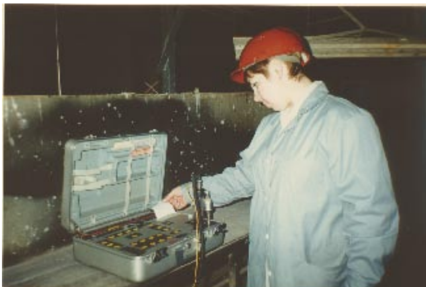
Foto 4. Controlul gazelor de coș la SA „ CET-2” or. Chișinău
