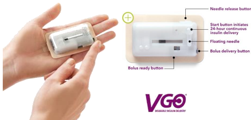
Figura 45: bomba en parche de Valeritas y descripción de las partes, dispositivo V-Go®.
