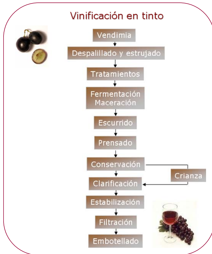
Figura 4. Etapas del proceso de vinificación tradicional de vinos tintos.
