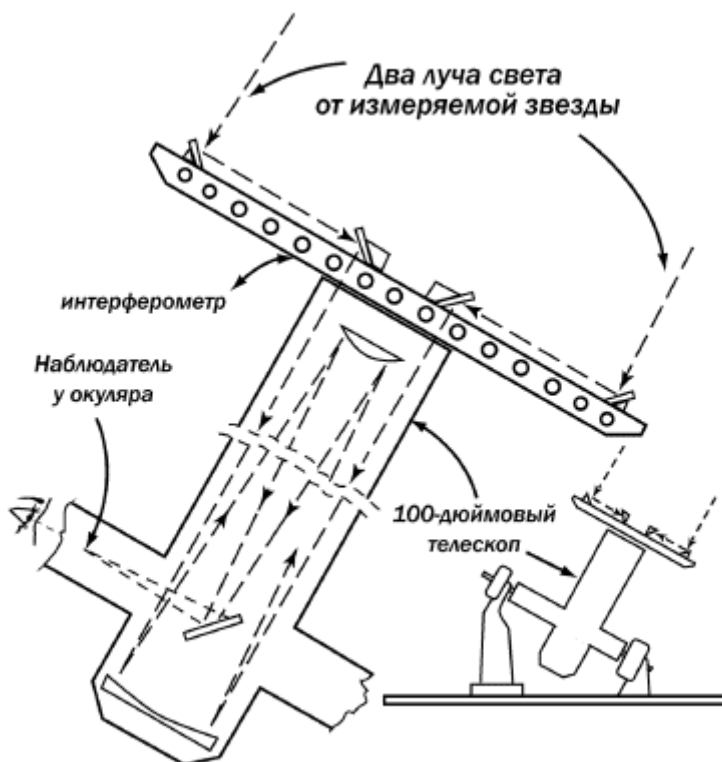
Рис. Схема установки, поясняющей устройство прибора интерферометра для измерения угловых диаметров звезд
