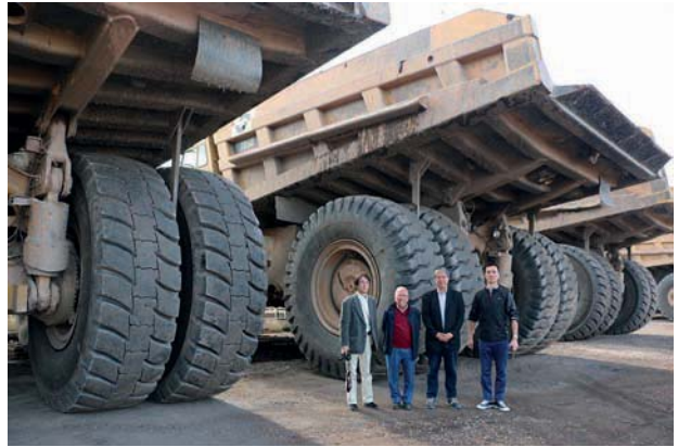
Figura 13. Camiones dumper de la Mina Santa María de 78 m 3 de capacidad máxima y hasta 250 toneladas de desplazamiento a plena carga.
