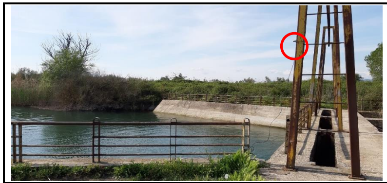
Εικόνα 3-4 Το μικρόφωνο σε στύλο 3m που συνδέεται με το καταγραφικό SM4BAT-FS στη λίμνη Τριχωνίδα.
