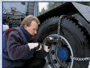
Die Ketten durch das Felgenloch ziehen und ankurbeln.
