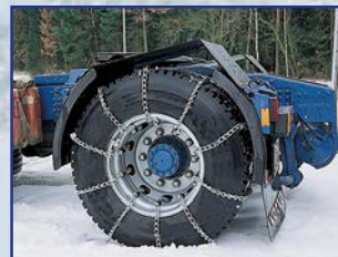
Nach Einsatzbedingung können bis zu 10 Stränge montiert werden.
