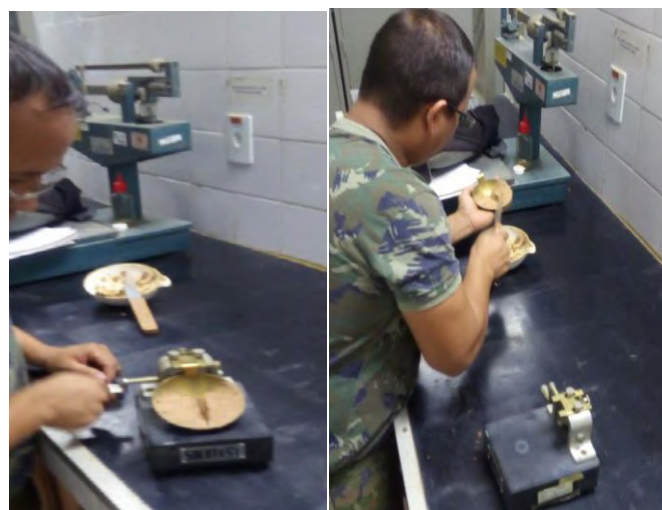
Figura 2.4 – Preparação e execução do ensaio de LL.
