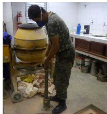
Figura 2.6 – Preparo de corpo de prova para o ensaio de Compactação.
