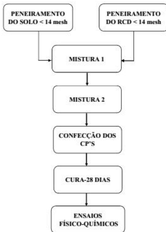
Figura 2.11 – Fluxograma das etapas finais de procedimento experimental.
