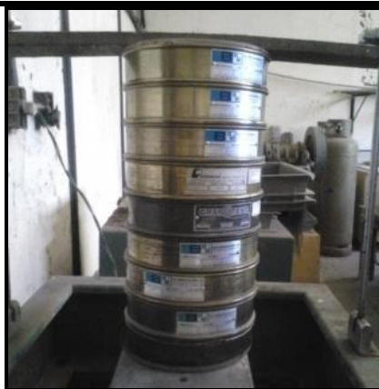
Figura 2.9 – Operação de peneiramento.
