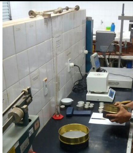
Figura 2.5– Separação de peneiras para realização do ensaio.
