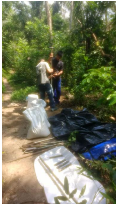
Figura 2.2 - Perfuração do solo com trado.
