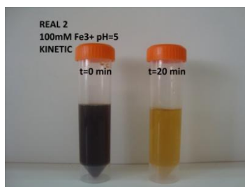
Σχήμα 4.5.1: (α) Επίδραση του χρόνου κροκίδωσης στο υπολειμματικό χρώμα (πραγματικό απόβλητο ‘δείγμα 2’, [Fe^{3+}] = 100 \text{ mM} , pH = 4, 5, 7, 9 ), (β) Τα αποτελέσματα εκφρασμένα σε απομάκρυνση % (R%). Η συνεχής γραμμή παριστά το κινητικό μοντέλο κροκίδωσης, (γ) Φωτο αποβλήτου πριν και μετά την επεξεργασία με κροκίδωση.
