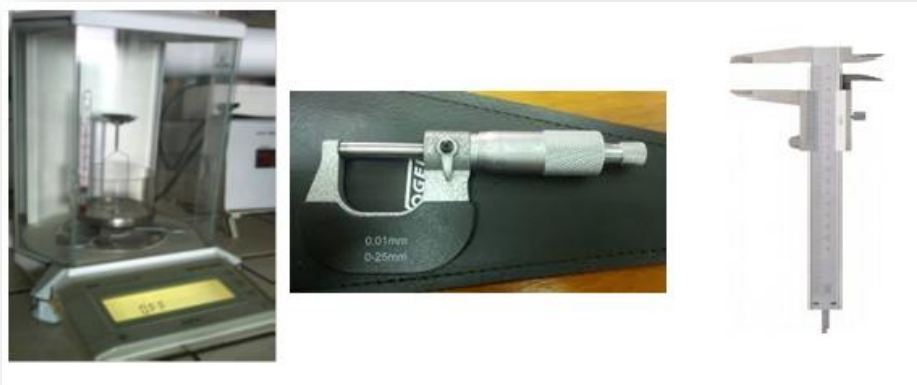
Εικόνα 18. (α) Ζυγός MettlerToledoAG64 με ειδική διάταξη, (β) Μικρόμετρο Profi ακριβείας 0,01 mm, (γ) Παχύμετρο RaboneChestermanLtd. VernierCalliper.
