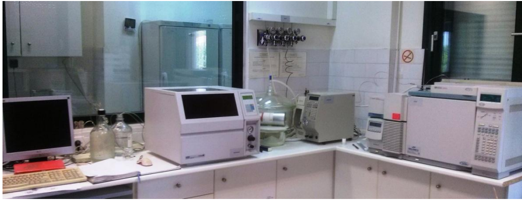
Εικόνα 6. Όργανα μέτρησης πτητικών: Αυτόματος δειγματολήπτης (OI Analytical, 4552), Purge & Trap (OI Analytical, 4560) και GC-MS (Agilent, 6890).
