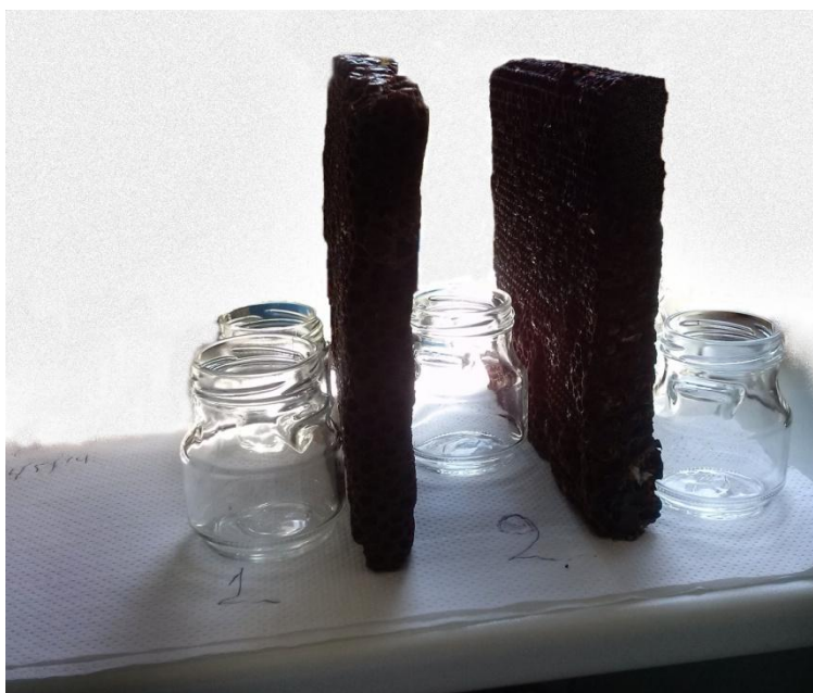
Εικόνα 8. Τοποθέτηση και στήριξη των πλαισίων σε κάθετη θέση, για την παραμονή τους σε συνθήκες περιβάλλοντος για μία εβδομάδα.
