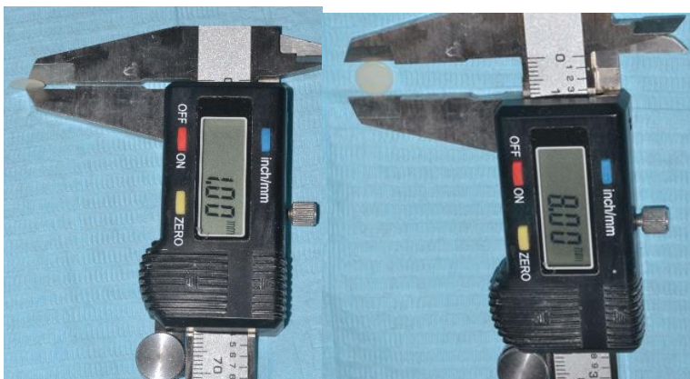
Εικόνα Β1δ:Επιβεβαίωση διαστάσεων δοκιμίων με ηλεκτρονικό διαστημόμετρο ακριβείας.
