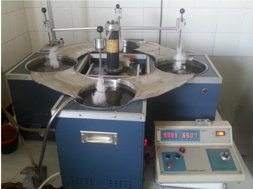
Εικόνα Β1ε:Συσκευή κυκλικά επαναλαμβανόμενης θερμικής καταπόνησης
