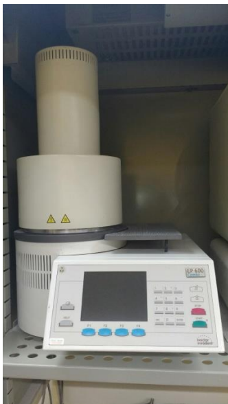
Εικόνα Β1γ: Φούρνος πρεσαρίσματος κεραμικών Ivoclar Vivadent, EP 600, Combi
