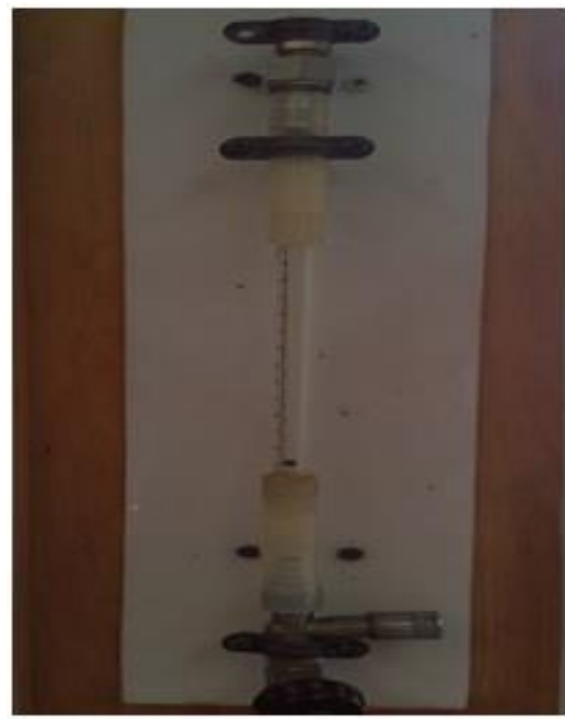
Σχήμα 3.5.2: (α) Μανόμετρο τροφοδοσίας (β) Ροόμετρο αέρα.
