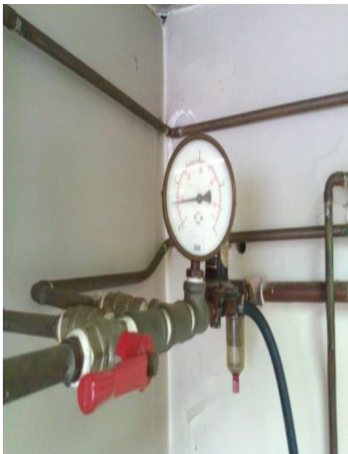
Σχήμα 3.5.2: (α) Μανόμετρο τροφοδοσίας (β) Ροόμετρο αέρα.
