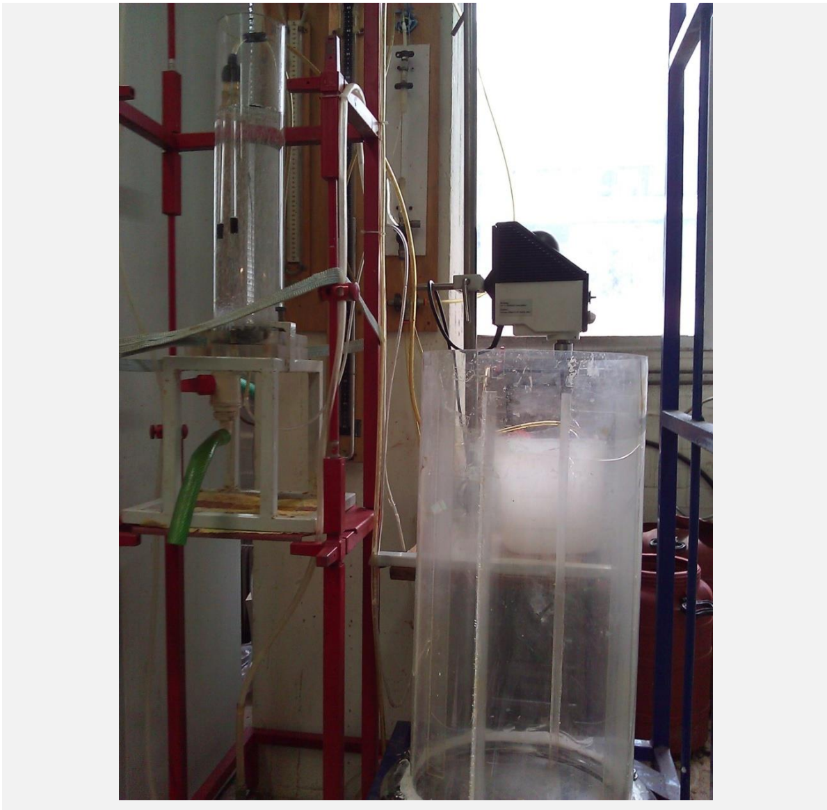
Σχήμα 3.5.1: Υβριδική συσκευή επίπλευσης.
