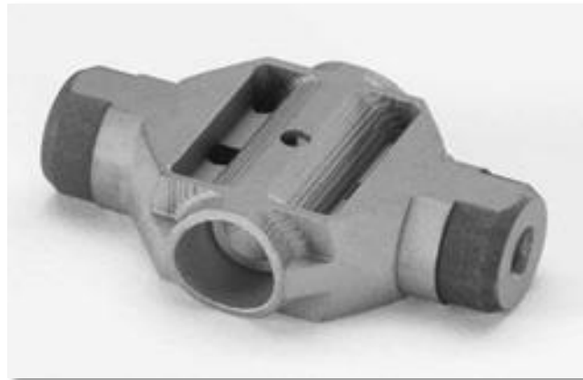
Σχήμα 11. Εγκάρσια θερμαινόμενος φούρνος γραφίτη (THGA).
