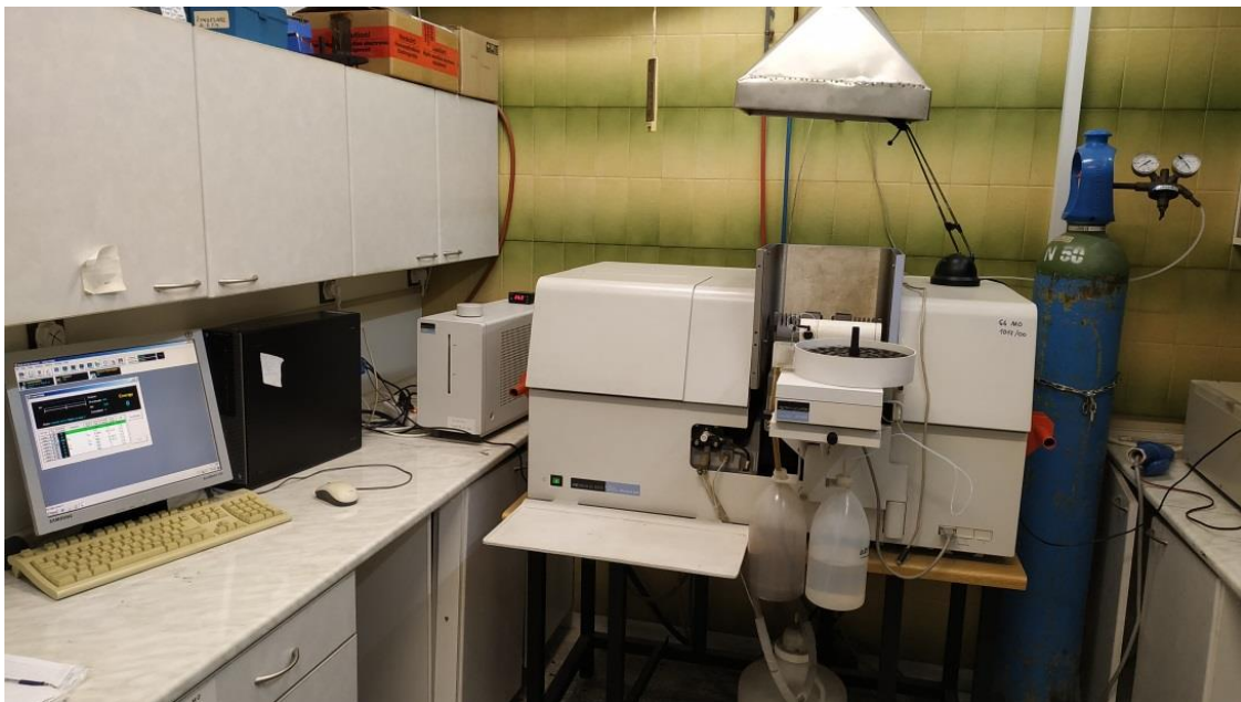
Σχήμα 15. Φασματοφωτόμετρο ατομικής απορρόφησης με φλόγα-φούρνο γραφίτη μοντέλο AA Analyst 800 της εταιρίας Perkin Elmer.
