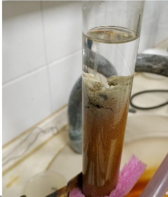
Σχήμα 40. Διαβρωμένο υλικό \text{FeOOH}/2,5 .
