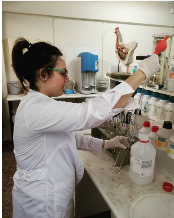
Εικόνα 6. Χημικός προσδιορισμός ολικού αζώτου (N) με τη μέθοδο Kjeldahl (A.O.A.C. 2000).
