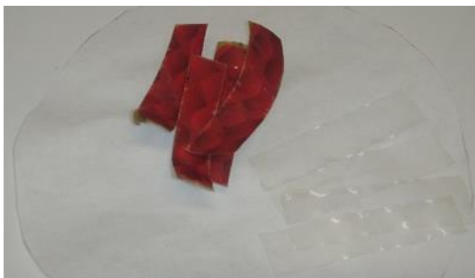
Εικόνα 59 Πολυστρωματικό φιλμ 1 μετά από κατεργασία με 3ml οξικό οξύ + 2ml αιθανόλη +5ml H 2 O
