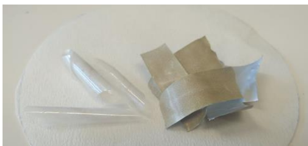
Εικόνα 64 Πολυστρωματικό φιλμ 2 μετά από κατεργασία με 10ml μεθανόλη
