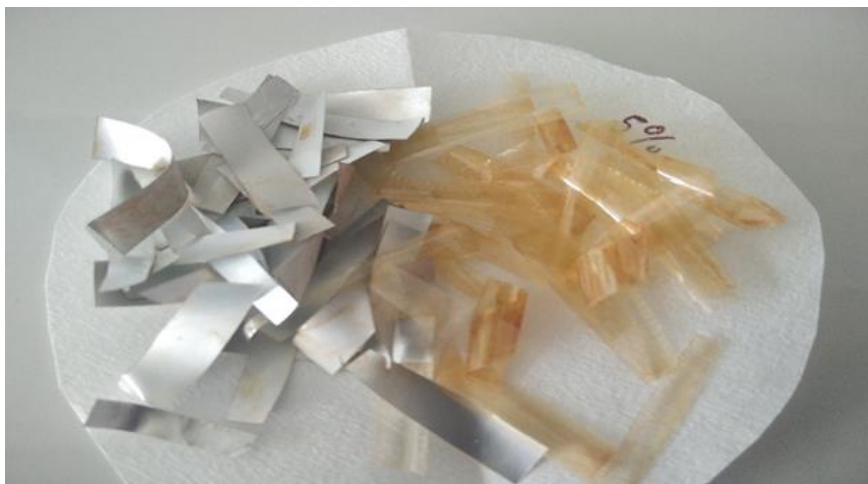
Εικόνα 50 Πολυστρωματικό φιλμ 1 μετά από κατεργασία με 10ml ακετόνη
