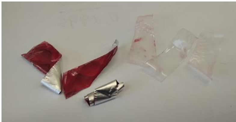
Εικόνα 53 Πολυστρωματικό φιλμ 1 μετά από κατεργασία με 10ml τολουόλιο
