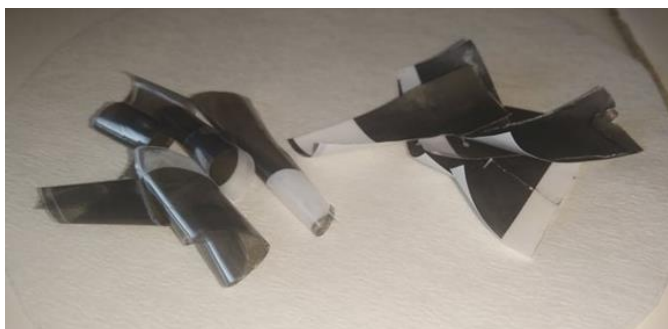
Εικόνα 67 Πολυστρωματικό φιλμ 3 μετά από κατεργασία με 10ml ακετόνη
