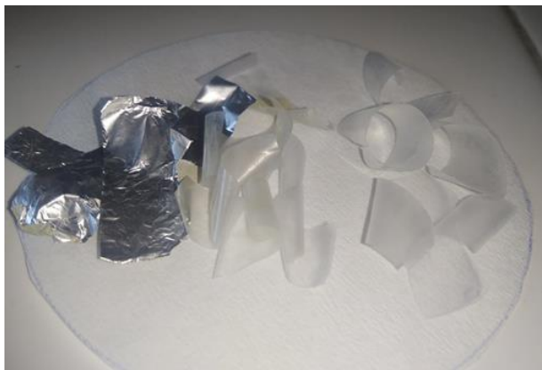
Εικόνα 63 Πολυστρωματικό φιλμ 2 μετά από κατεργασία με 10ml διμέθυλοφορμαμίδιο
