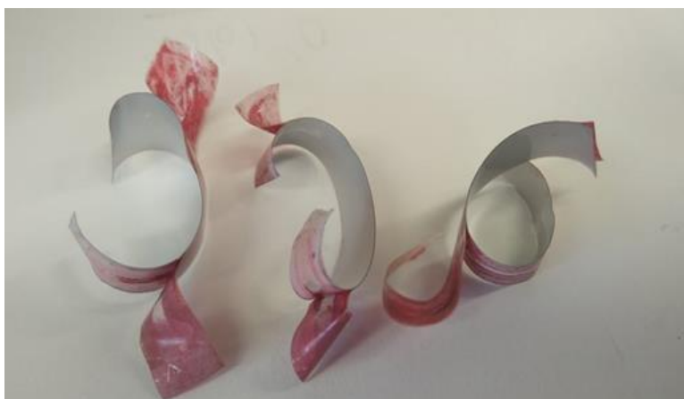
Εικόνα 54 Πολυστρωματικό φιλμ 1 μετά από κατεργασία με 10ml αιθανόλη
