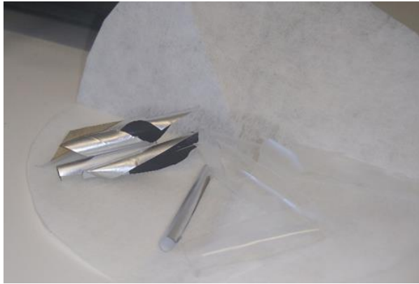
Εικόνα 62 Πολυστρωματικό φιλμ 2 μετά από κατεργασία με 10ml τολουόλιο
