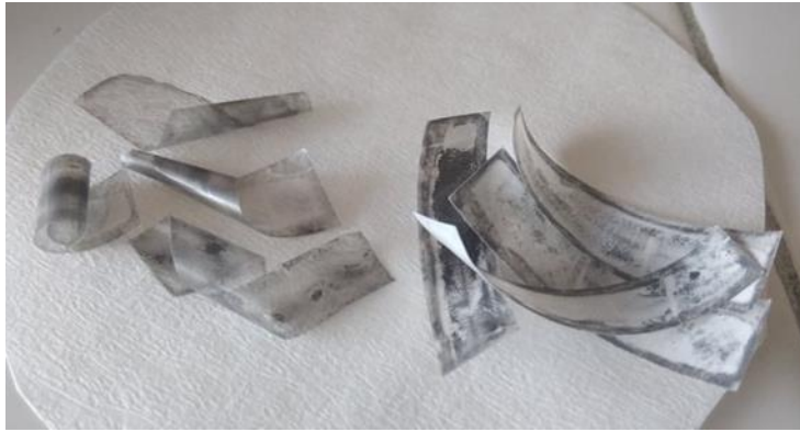
Εικόνα 68 Πολυστρωματικό φιλμ 3 μετά από κατεργασία με 10ml μεθανόλη
