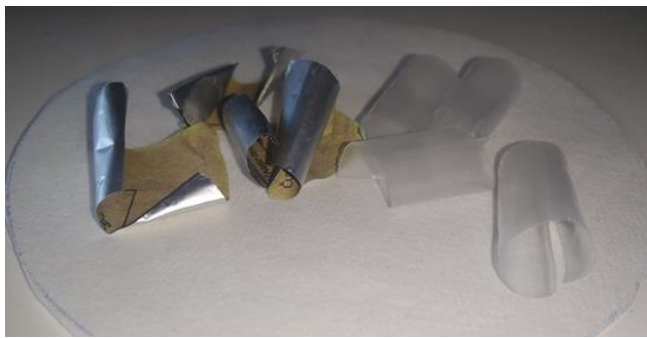
Εικόνα 66 Πολυστρωματικό φιλμ 2 μετά από κατεργασία με 3ml διμέθυλοφορμαμίδιο + 2ml αιθανόλη +5ml H 2 O
