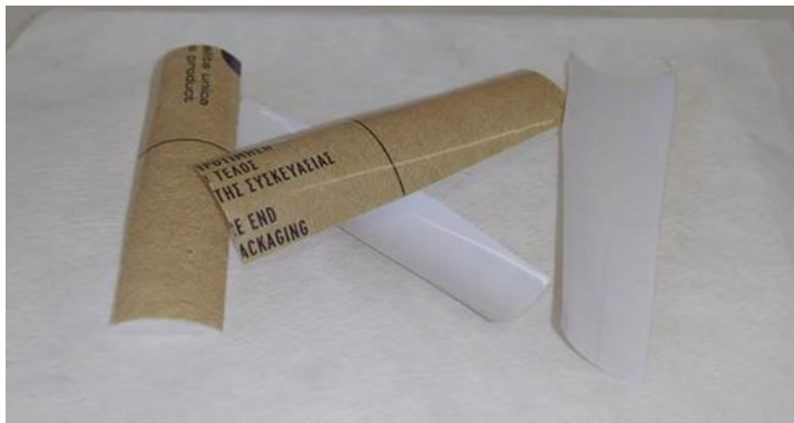
Εικόνα 72 Πολυστρωματικό φιλμ 4 μετά από κατεργασία με 10ml οξικό οξύ
