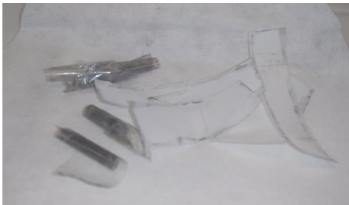
Εικόνα 69 Πολυστρωματικό φιλμ 3 μετά από κατεργασία με 10ml οξικό οξύ
