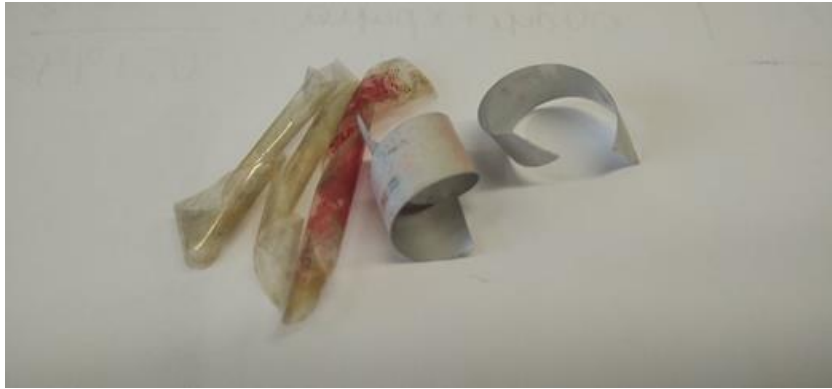
Εικόνα 52 Πολυστρωματικό φιλμ 1 μετά από κατεργασία με 10ml διμέθυλοφρμαμίδιο
