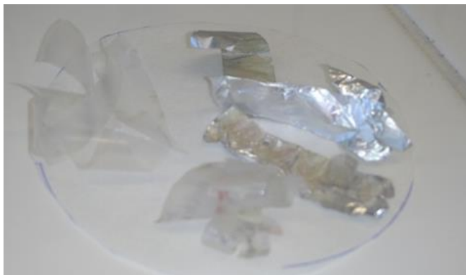
Εικόνα 61 Πολυστρωματικό φιλμ 2 μετά από κατεργασία με 10ml οξικό οξύ
