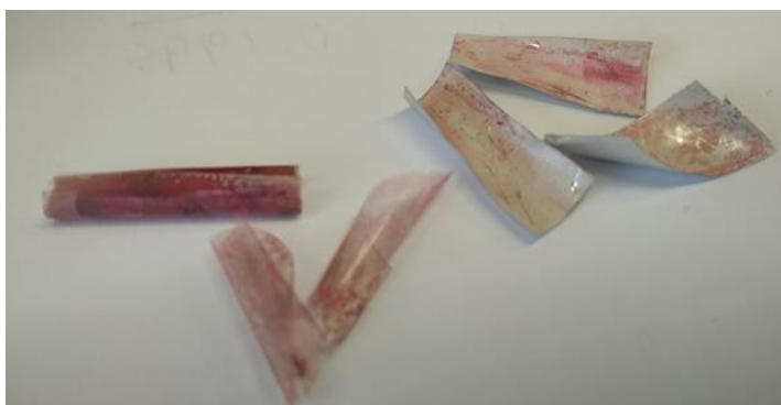
Εικόνα 55 Πολυστρωματικό φιλμ 1 μετά από κατεργασία με 10ml μεθανόλη
