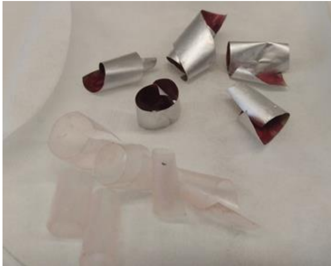
Εικόνα 57 Πολυστρωματικό φιλμ 1 μετά από κατεργασία με 3ml διαιθυλεστέρας + 2ml αιθανόλη +5ml H 2 O
