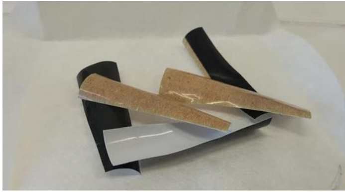
Εικόνα 71 Πολυστρωματικό φιλμ 4 μετά από κατεργασία με 10ml οξικό οξύ
