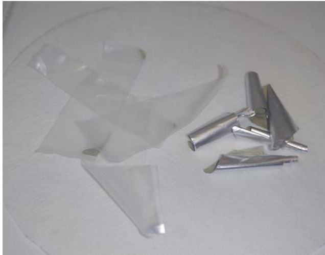
Εικόνα 65 Πολυστρωματικό φιλμ 2 μετά από κατεργασία με 3ml οξικό οξύ + 2ml αιθανόλη +5ml H 2 O
