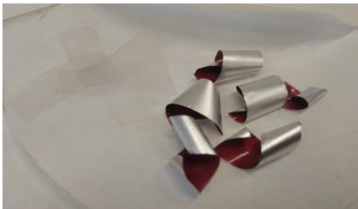
Εικόνα 56 Πολυστρωματικό φιλμ 1 μετά από κατεργασία με 3ml τολουόλιο + 2ml αιθανόλη +5ml H 2 O
