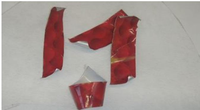
Εικόνα 58 Πολυστρωματικό φιλμ 1 μετά από κατεργασία με 3ml μεθανόλη + 2ml αιθανόλη +5ml H 2 O
