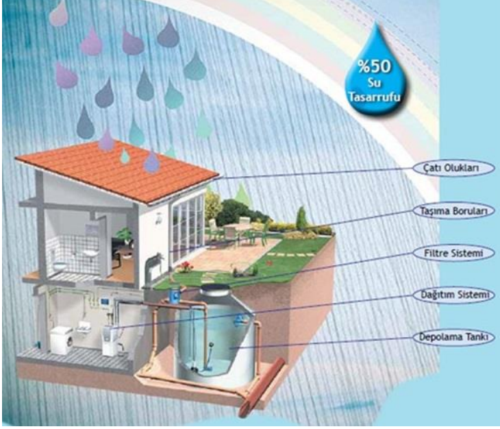
Şekil 3: Çatı yüzeyinden yağmur suyu toplama sistemi (Anonim,2014)
