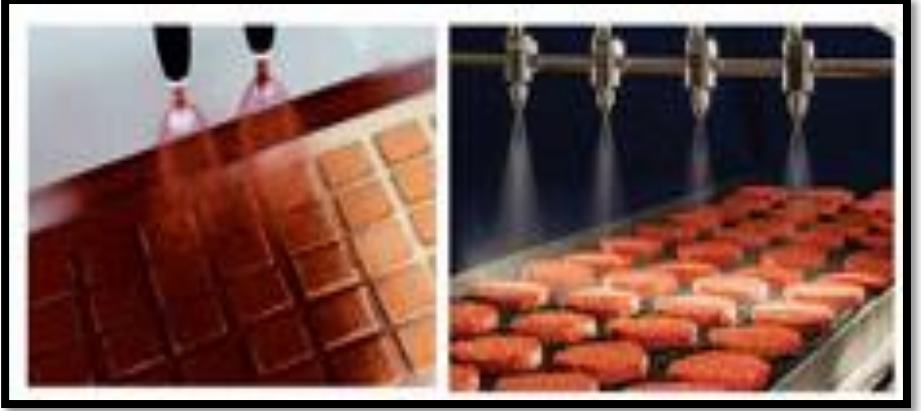
Şekil 6. Püskürtme Yöntemi ile Yapılan Kaplama (Anonim, 2021).
