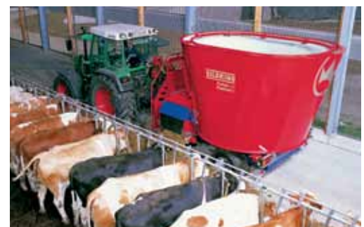
Der Schlepper zieht den Futtermischwagen nicht nur, er treibt ihn auch über eine Welle an, sodass er gleichmäßig Futter am Fressgitter der Kühe ablegt.
