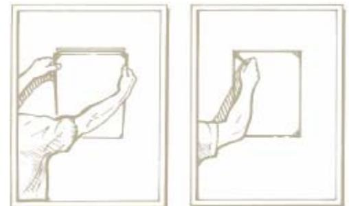
④ Positionnez votre panneau Amina<sup>®</sup> et connectez le câble haut-parleur. Ensuite, vissez les panneaux sur les 4 pattes de fixations. Ajustez la pression de ces 4 vis afin que votre panneau soit d'aplomb au mur. Il ne doit plus y avoir de jeu, le panneau doit être bien stable.
