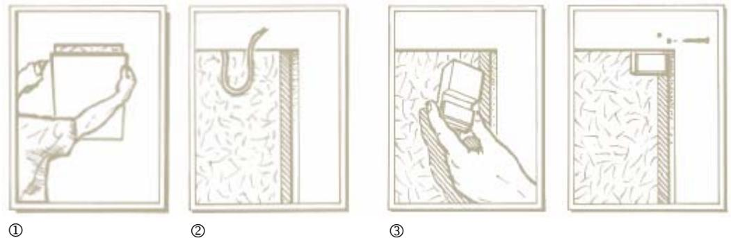
① A l'aide d'un cutter, faites une ouverture de 450mm x 345mm dans votre cloison sèche que se soit au plafond ou dans un mur. Découpe conseillée : 452 x 347 x 40mm.
