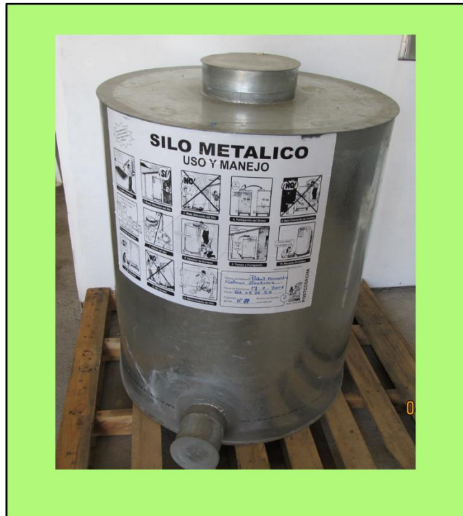
Figura No. 50. Fotografía de un silo metálico de 15 quintales de capacidad. En la parte superior la apertura de llenado de semillas, y en la parte inferior el conducto de vaciado del contenido. Se observa la etiqueta que va adherida a cada unidad indicando su uso y manejo. El silo es colocado sobre polines de madera para aislarlo de la humedad del piso y reciba aireación en toda la superficie exterior del silo. Fotografía de Néstor Bonilla Bird.
