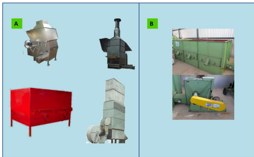
Figura No. 21. Fotografías mostrando secadores estacionarios de fabricación nacional (A) parte superior hornos de cascarillas para fuego indirecto de 2 a 4 millones de BTU. Izquierda parte inferior secador estático de 40 a 100 quintales de capacidad. Parte inferior derecha, secadores
