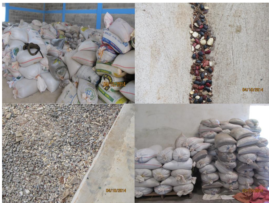
Figura No. 8. Áreas de recepción de semillas en plantas con ningún control de calidad. Se puede observar el desorden en el arreglo de los sacos en la recepción, la falta de limpieza en las áreas aledañas al área de recepción. Las estibas de sacos de polietileno, completamente desordenadas y sin protección, completamente en contacto con el piso de concreto absorbiendo la humedad del suelo. Fotografías Néstor Bonilla Bird.
