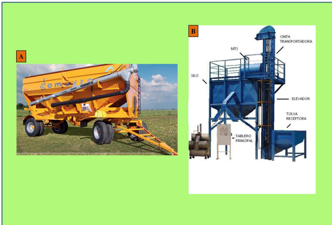
Figura No.16. Fotografía (A) muestra tolva de auto descarga móvil. Fotografía (B) muestra tolva fija, normalmente ubicadas al inicio del proceso de acondicionamiento de semillas. Industrias COMORFA ( http://www.industriascomofra.com.ar/ ) y Fotografía (B) METECHEGARAY. ( http://www.metechegaray.com.ar/ ).
