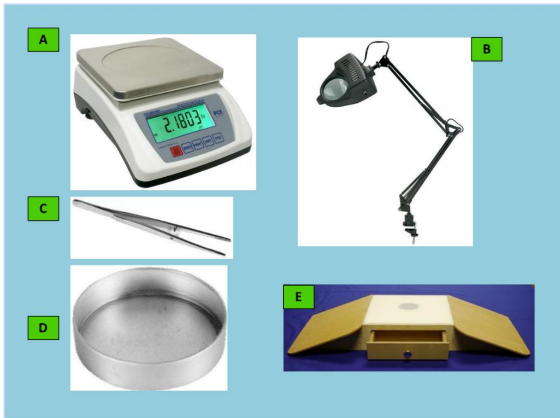
Figura No.14. Equipos requeridos para el control realizar los análisis de pureza física y obtención de muestra para determinación del porcentaje de germinación. A. Balanza digital electrónica de cuatro dígitos. B. Lámpara con lente para escritorio. C. Pinza. D. Plato de aluminio para separación de componentes físicos de la muestra. E. Mesa de trabajo para realizar análisis de pureza física. Fotos tomadas del catálogo de Seedburo ( http://www.seedburo.com ).
