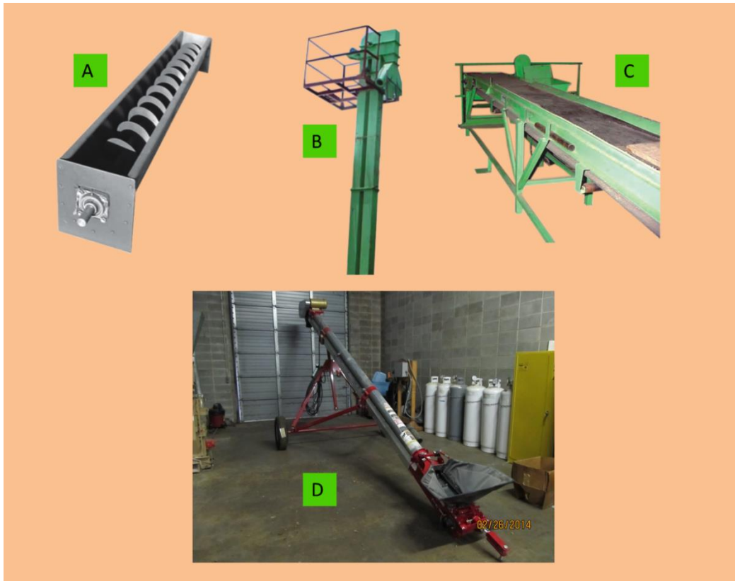
Figura No. 7. Equipos empleados en los puntos de entrada de los lotes de semillas a las plantas de acondicionamiento. Fotografía (A) transportador helicoidal de 10 a 50 cm de diámetro. Fotografía (B) elevador de cangilones de aproximadamente 90 kg a 180 kg/h (20 a 40 qq/h). Fotografías (C) transportador de banda para sacos de polietileno de 50 kg. Fotografías (A, B y C) facilitadas por FIATA-Nicaragua. Fotografía (D) Elevador helicoidal. Fotografías Néstor Bonilla Bird.
