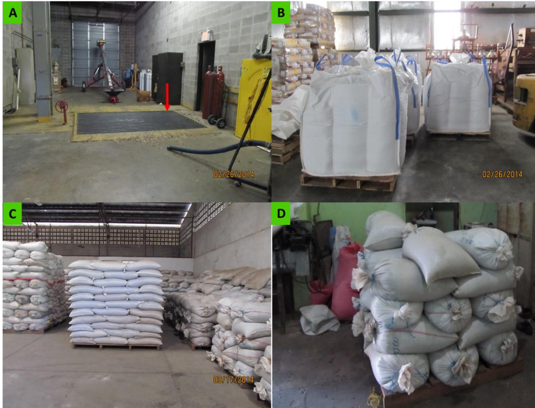
Figura No. 6. Diferentes formas de recepción de semillas en las plantas de procesamiento industrial. Fotografía (A) muestra tolva de recepción de bajo nivel, en el piso se observa un enrejado metálico por donde se descargan las semillas por gravedad. Fotografía (B) recepción de semillas en bolsas de polietileno de 1,000 kg. Fotografías (C y D) recepción de semillas en sacos de polietileno de 50 kg. Fotografías Néstor Bonilla Bird.
