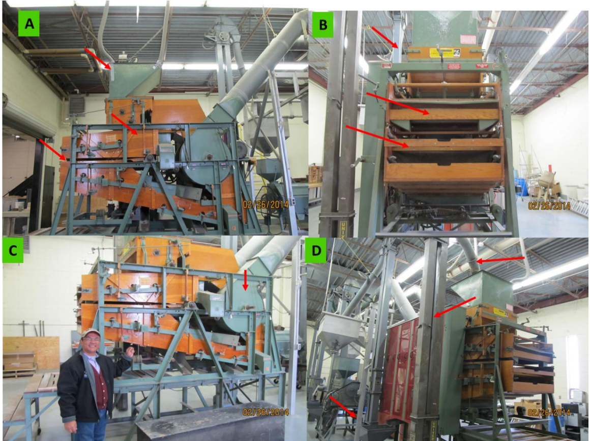
Figura No. 35. Diferentes vistas de la máquina clasificadora a base de aire-zaranda en el beneficiado de semillas. En cada fotografía se indican en orden descendiente las descripciones con su respectiva flecha roja. (A) obsérvese la tolva de recepción en la parte superior. Cuatro zapatas de soporte ubicadas lateralmente a los soportes de las zarandas, delgadas líneas en posición vertical. La disposición de las zarandas en ( \gt ) para hacer la vibración cero del movimiento de los ejes excéntricos. (B) vista de disposición de zarandas desde el sitio del operador de equipo, lugar de observación del proceso de limpieza y clasificación de las semillas. (C) vista del ventilador de succión de impurezas de menor peso específico que las semillas. (D) obsérvese en la parte superior el transportador de descarga en la tolva de alimentación del equipo aire-zaranda. Lateralmente se observa elevador de cangilones. En la parte inferior se observa el punto de descarga de la semilla seleccionada de primera calidad que es vertido nuevamente al transportador de cangilones para continuar con las operaciones de clasificación.
