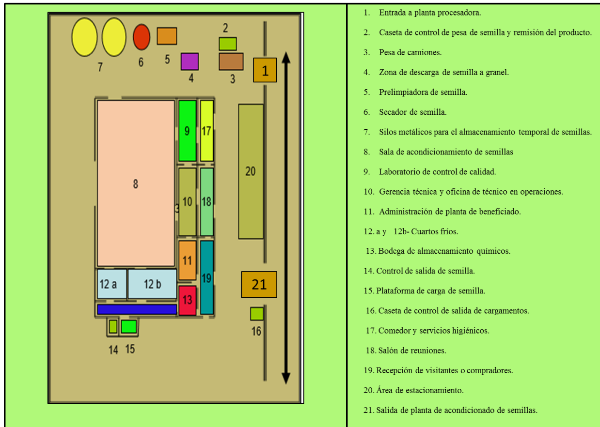
Figura No. 58. Plano sugerido para la distribución horizontal de áreas de trabajo en una planta de procesamiento y clasificación de semillas. Adaptado de Brooker Donald (1992). Drying and Storage of Grain and Oil Seeds. USA.
