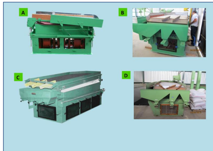
Figura No. 45. Fotografías de equipos para realizar la clasificación por densimetría (A) capacidad de equipos de 20 a 80 quintales por hora. Fotografías suministradas por FIATA-Nicaragua. (B) Fotografía de equipos densimétrica de 80 quintales por hora de capacidad. (C) y (D) SABINA Industrial de 80 quintales por hora. Fotografías Néstor Bonilla Bird.
