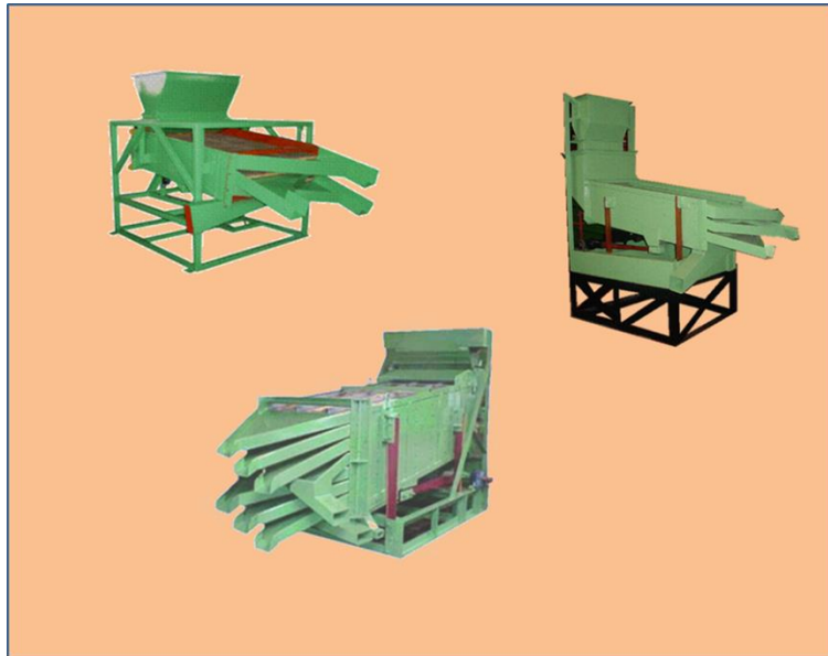
Figura No. 33. Fotografías mostrando clasificadores por tamaño de semillas, basados en sistema aire- zarandas. Estas tienen una capacidad de 20 a 100 quintales por hora. Fotografías facilitadas por FIATA-Nicaragua.
