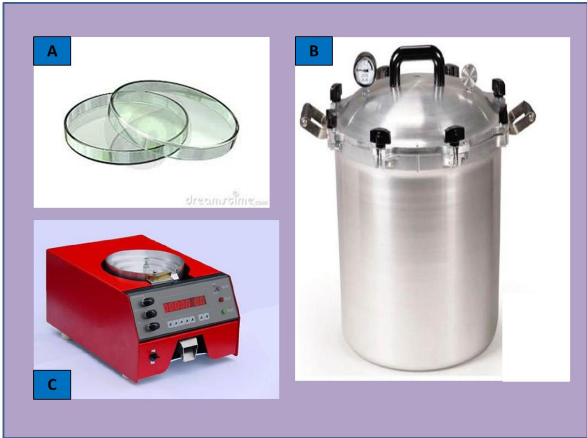
Figura No.15. Equipos de apoyo para los análisis de calidad de muestras de semillas en el laboratorio. (A) Platos Petri utilizados para pruebas de germinación. (B) Autoclave para la esterilización de cristalería. (C) Contador digital de semillas. Fotos tomadas del catálogo de Seedburo ( http://www.seedburo.com ).
