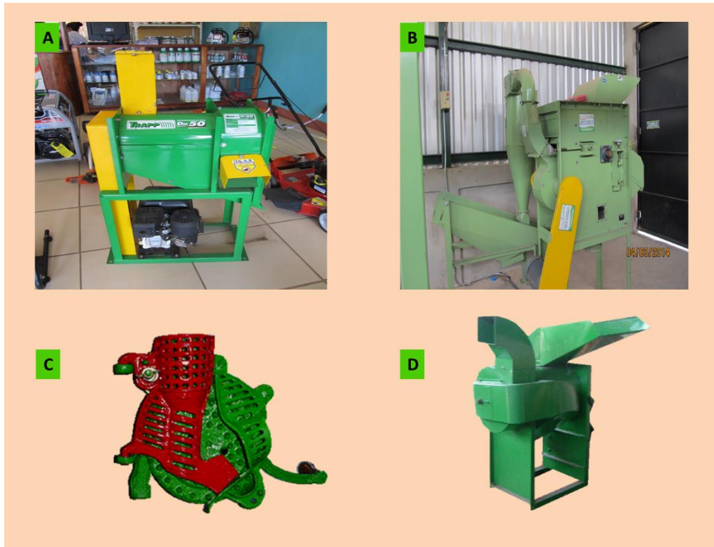
Figura No. 2. Equipos desgranadores de mazorcas de maíz. (A) Desgranadora de 30 quintales/h. Distribuida por CHAMAGRO S.A. (B) Desgranadora de mazorcas de 50-80 qq/h. Fabricada por SABINA INDUSTRIAL. (C) Desgranadora manual para procesado a pequeña escala de semillas. (D) Desgranadora de maíz 50 qq/h. Fotografías facilitadas por FIATA. Fotografías (A y B) Néstor Bonilla Bird.
