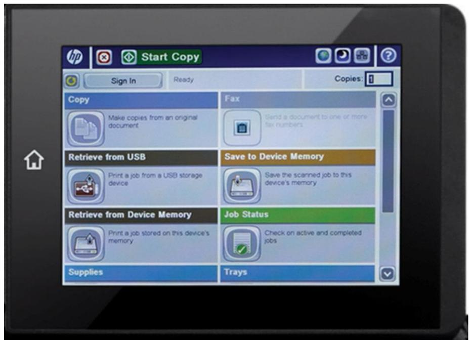
Bearbeiten Sie Arbeitsaufträge auf dem MFP mit dem HP Easy Select Farb-Touchscreen-Bedienfeld für ein reibungsloses Bedienerlebnis. Das Bedienfeld umfasst einen 20,3 cm (8 Zoll) großen grafischen SVGA-Touchscreen, der sich auf unterschiedliche Sichtwinkel einstellen lässt. Die Benutzeroberfläche ist die gleiche wie bei anderen HP LaserJet MFPs und vernetzten Scannern. So sparen Sie nicht nur Schulungs- und Helpdesk-Kosten, sondern machen Ihren Mitarbeitern auch das Leben leichter.
