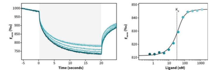
图 2. Hsp90 与 ADP MST 曲线 (左图) 及拟合曲线 (右图)
