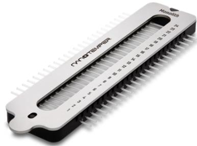
高品质的毛细管则保证了高品质的数据，使用毛细管的优势众多：仅需微量样品，在溶液中检测，接近天然环境，无需固定样品，甚至无需进行蛋白纯化。
