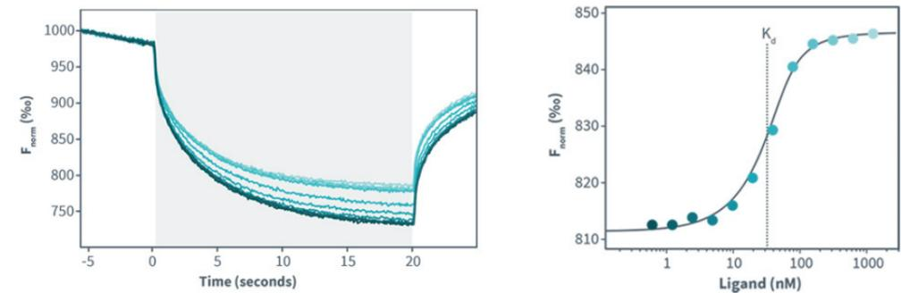
MO 系列仪器测量一个  $K_d$  值仅需 10 分钟，专家模式下最快仅需 90 秒，而无需额外冗长的数据分析。通过检测与配体结合后，荧光标记的蛋白或者具有自发荧光的样品的荧光强度在温度梯度中随时间而变化 (左图中灰色部分)，然后将选定时间段内的荧光强度对应配体浓度进行拟合作图，软件自动计算得到该结合的亲和常数  $K_d$  值 (右图)。
